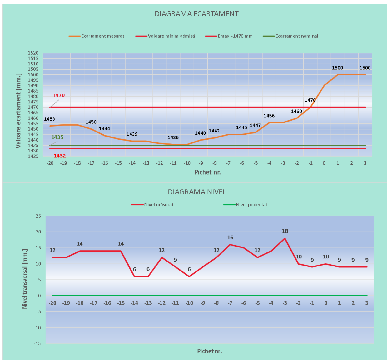
Imaginea nr.12 - valorilor măsurate ale ecartamentului și nivelului transversal
