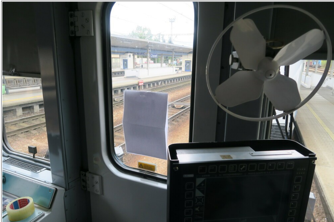
Obr. č. 6: Fotodokumentace z ověřovacího pokusu (výhled vestoje ze stanoviště strojvedoucího před čelo HDV přes list papíru formátu A4 imitující vylepený leták FSČR) Zdroj: DI
