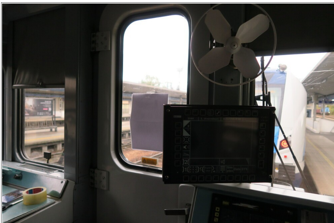
Obr. č. 5: Fotodokumentace z ověřovacího pokusu (výhled vsedě ze stanoviště strojvedoucího před čelo HDV přes list papíru formátu A4 imitující vylepený leták FSČR) Zdroj: DI
