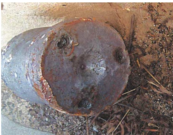
Figura 8 Aspetos do munhão da roda n.º 1 destruído
