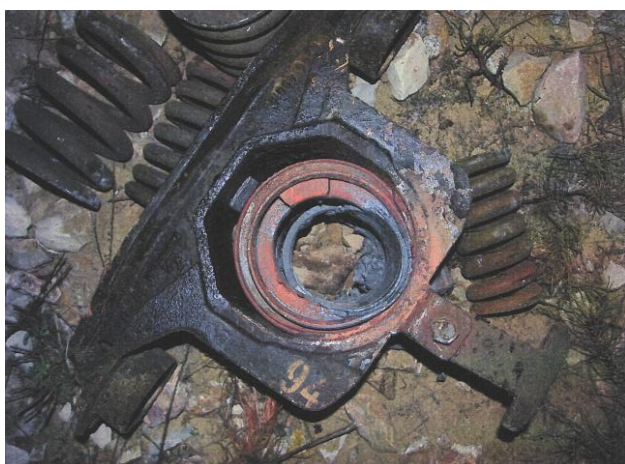
Figura 9 Caixa de eixo da roda n.º 1 com os restos do cartucho destruído (lado exterior)
