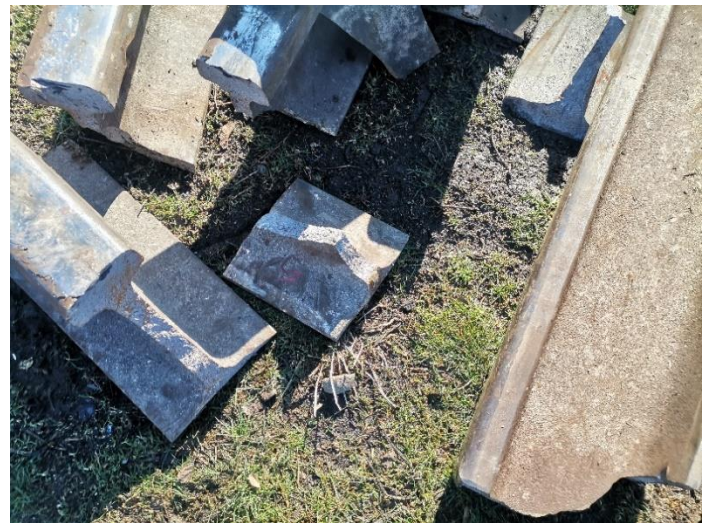
Foto nr.11 și 12. Fragmente din șina de pe firul din partea dreaptă ruptă în diverse secțiuni
