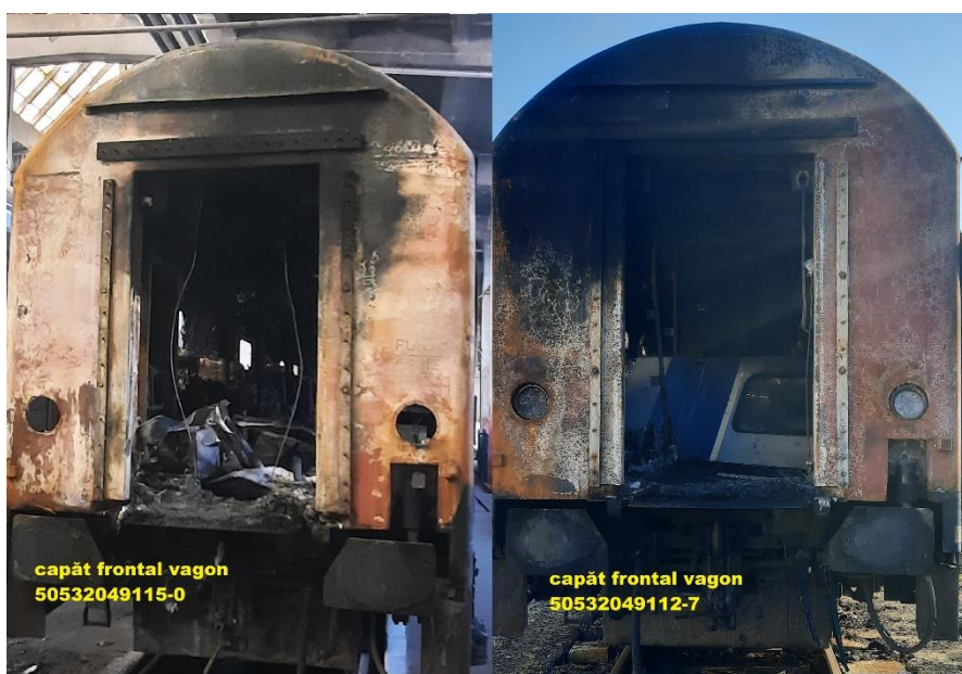
Imaginea nr.8.- depunerea de funingine pe capetele frontale ale vagoanelor
