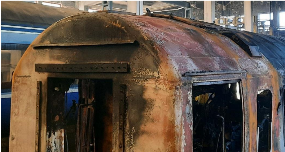
Imaginea nr.6 - acoperiș deformat al cutiei vagonului în zona cabinei de toaletă
