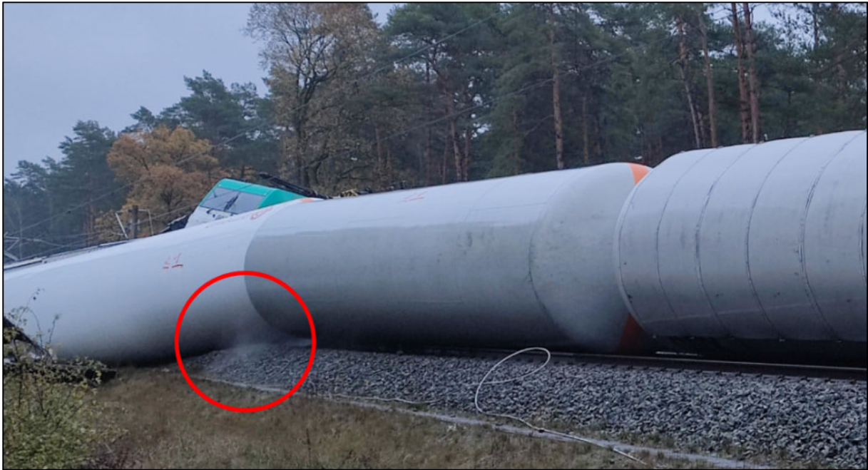
Abbildung 4: Propangasaustritt an einem Kesselwagen des DGS 42593
