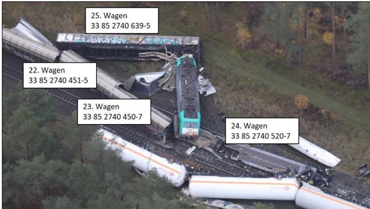
Abbildung 14: Positionen der beschädigten Wagen des DGS 90977 8
