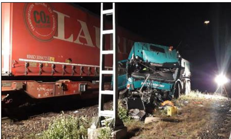
Abbildung 4: Beschädigter Lkw und zerstörtes Lichthauptsignal X2 4
