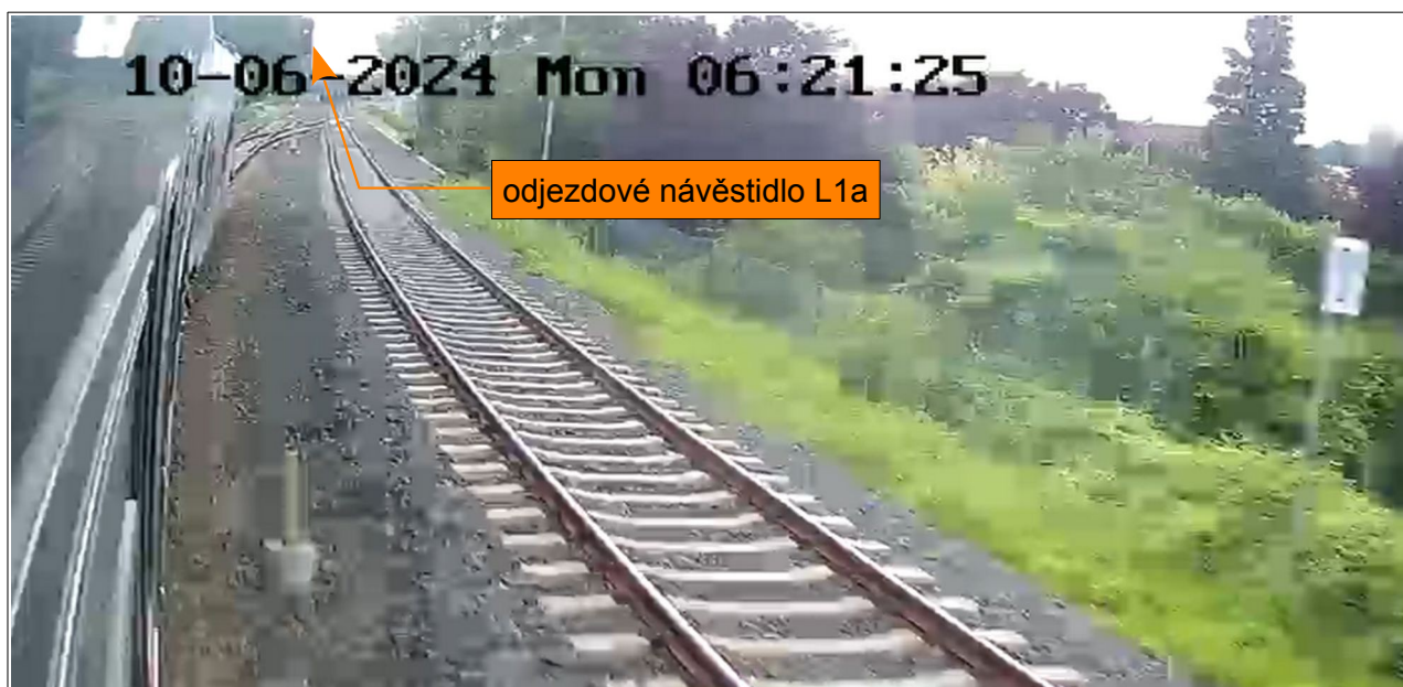
Obr. č. 6: Snímek ze záznamu z kamery umístěné na bočnici motorové jednotky vlaku Os 15186 po korekci času v 6:21:23 h (2 s před vznikem MU), kdy se přední čelo vlaku Os 15186 nacházelo 20,4 m před odjezdovým návěstidlem L1a žst. Chrudim, na kterém byla zřetelně vidět rozsvícená návěsní svítidla na pozici druhá shora (třetí zespoda) sestavy návěsních svítlen.
