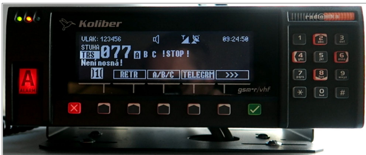
Obr. č. 3: Pohled na displej ovladače vozidlové RDST Koliber, na kterém je indikován nápis „! STOP !“, a na červeně prosvětlené tlačítko „A ALARM“ vyžadující po strojvedoucím navázání spojení se zaměstnancem řídícím drážní dopravu v režimu nouzového volání, a to po přijetí kódovaného příkazu adresný „STOP“.
