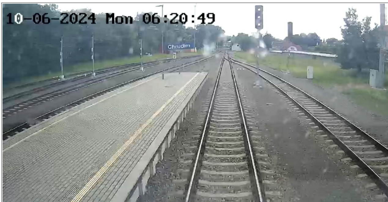
Obr. č. 5: Snímek ze záznamu z kamery umístěné na čelním skle motorové jednotky vlaku Os 15186 po korekci času v 6:20:47 h (38 s před vznikem MU), kdy se přední čelo vlaku Os 15186 nacházelo cca 15 m před odjezdovým návěstidlem L2 žst. Chrudim, na kterém byly zřetelně vidět tři rozsvícené návěstní svítilny.
