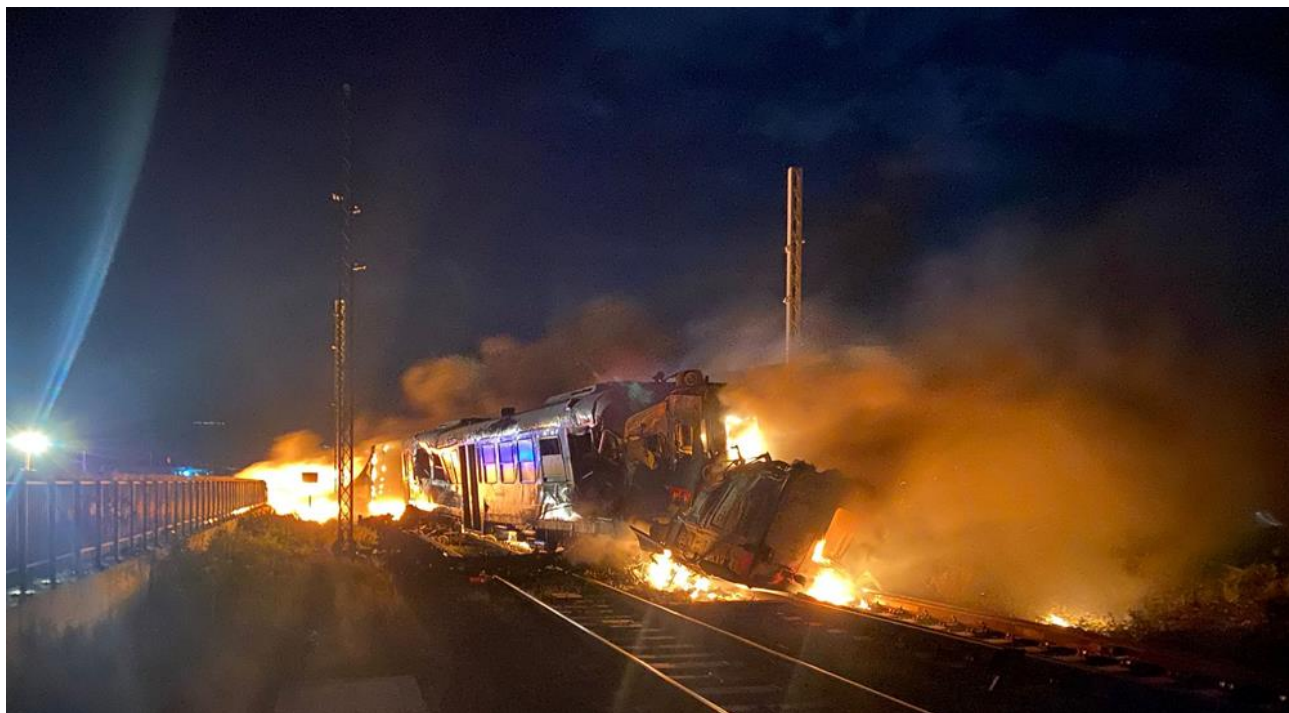
Figura 8: Svio del treno e incendio del semirimorchio (sulla sinistra) e della motrice dell'autoarticolato (sulla destra) (fonte RFI)
