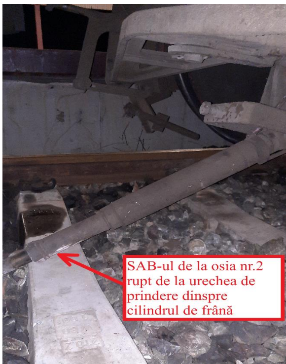
Foto nr.1 – SAB osia nr.2 – rupt
