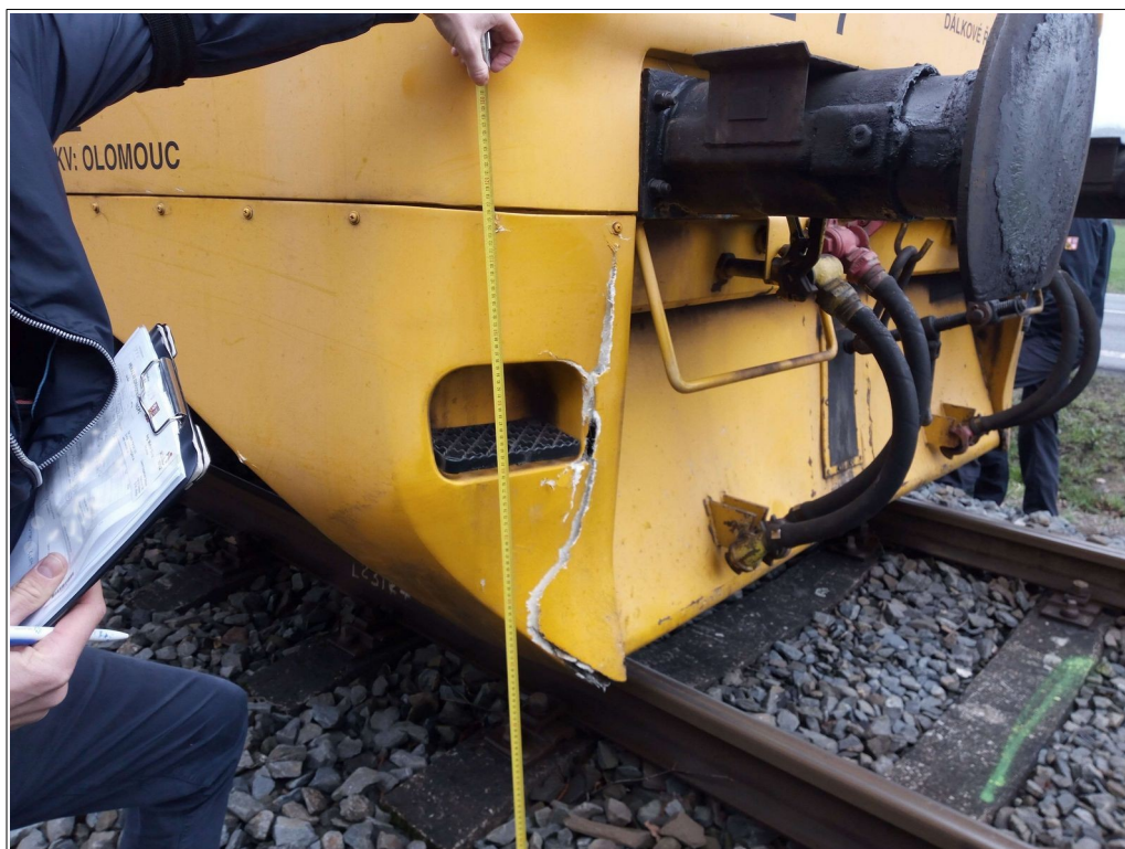
Obr. č. 2: Pohled na poškození čela HDV 814.052-7 po vzniku MU.
