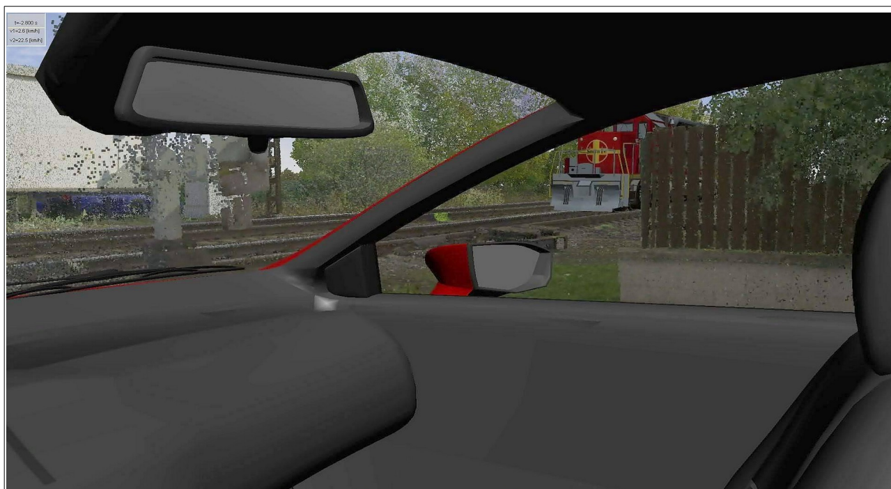
Obr. č. 6: Pomalý rozjezd čas 2,8 s před střetnutím (tj. 0,7 s po rozjezdu) – řidič mohl vidět celé čelo HDV Zdroj: ČVUT Praha
