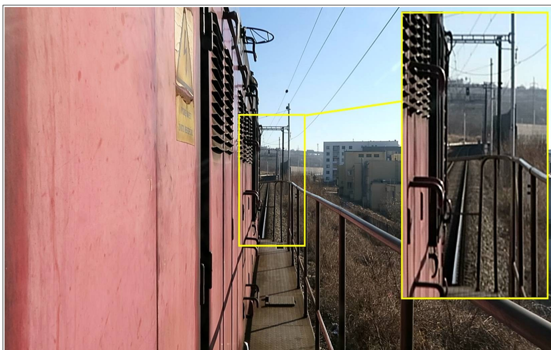
Obr. č. 14: Ilustrativní příklad výhledu strojvedoucího z 1. stanoviště obdobné řady HDV jedoucího dlouhým představkem vpřed (omezen výhled vlevo od osy koleje)
