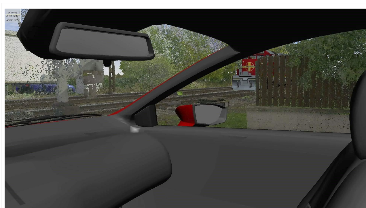
Obr. č. 8: Normální rozjezd, čas 3,0 s před střetnutím – řidič může vidět více než polovinu čela HDV
