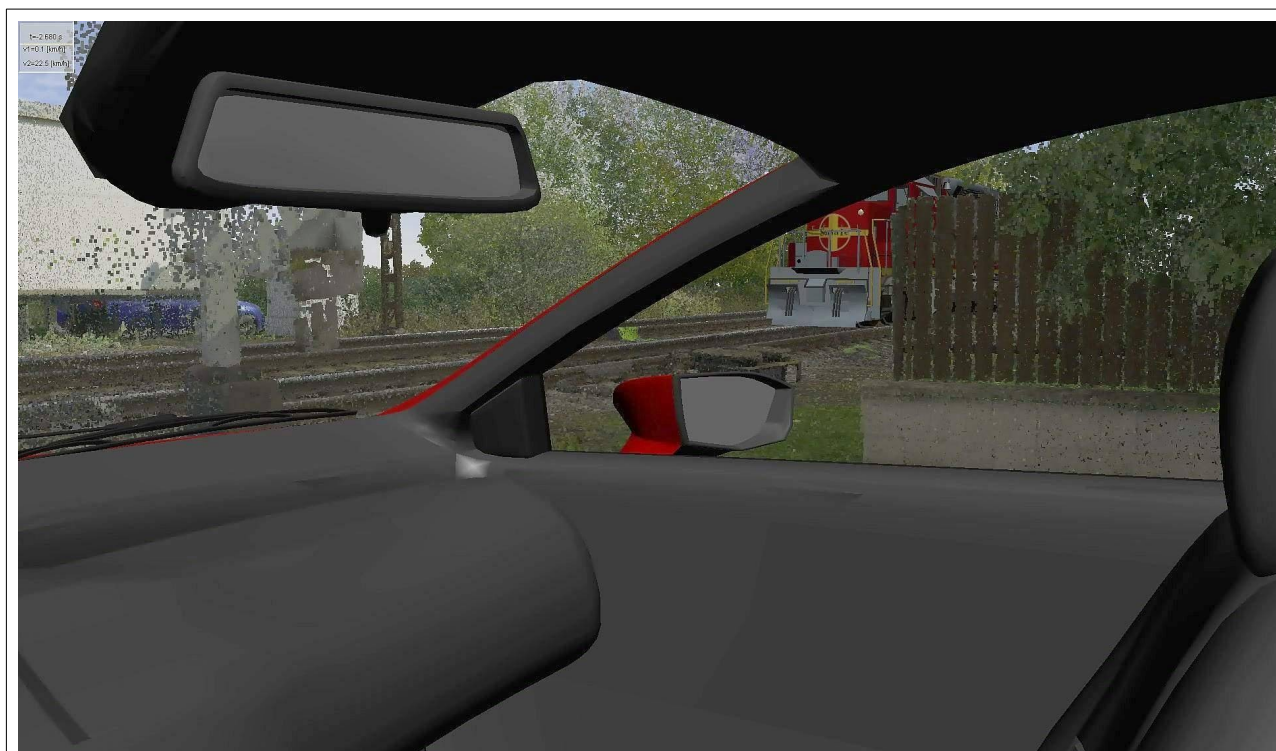
Obr. č. 9: Normální rozjezd, čas 2,68 s před střetnutím – okamžik rozjezdu; řidič může vidět celé čelo HDV Zdroj: ČVUT Praha
