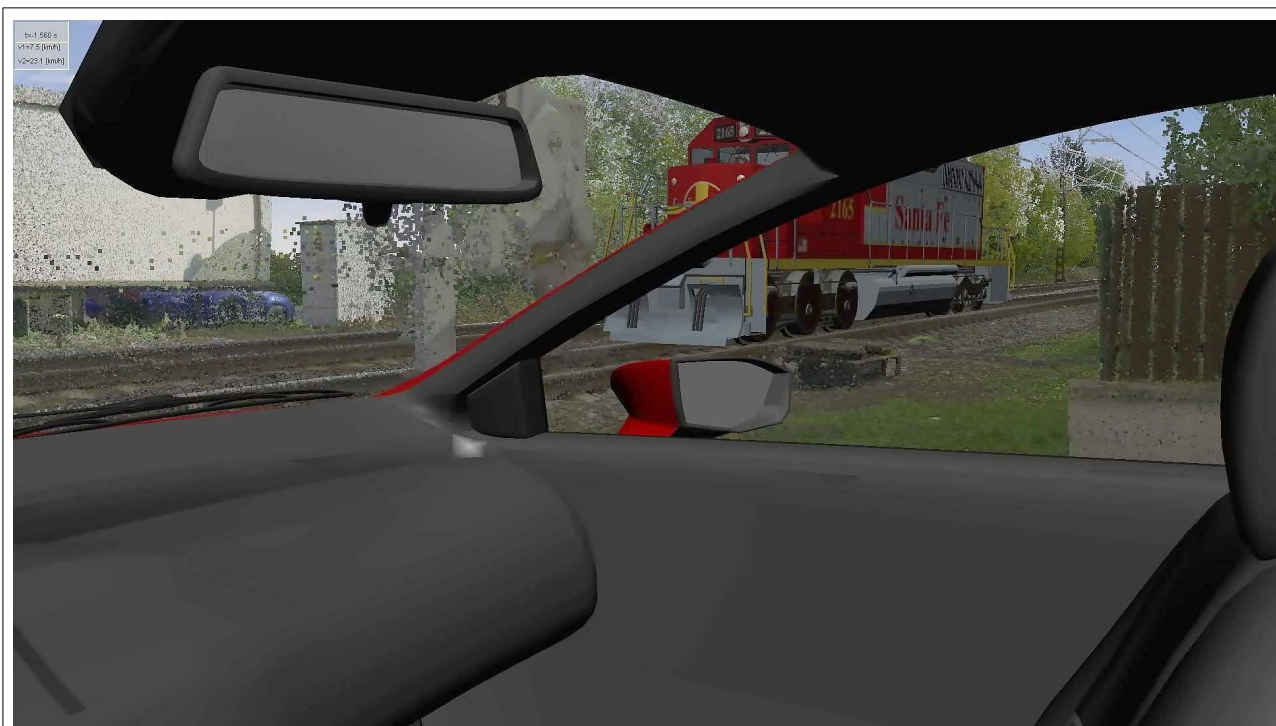
Obr. č. 10: Normální rozjezd, čas 1,56 s před střetnutím – řidič může vidět celé HDV Zdroj: ČVUT Praha
