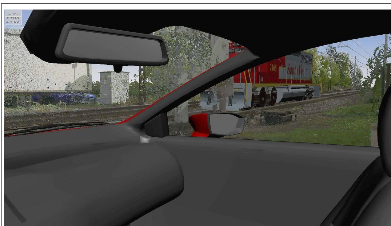
Obr. č. 7: Pomalý rozjezd čas 1,56 s před střetnutím – řidič mohl vidět celé HDV Zdroj: ČVUT Praha
