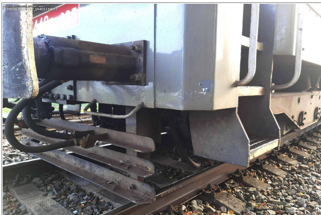
Obr. č. 13: Stopy střetnutí na HDV č. 620.122-4 soupravy PMD
