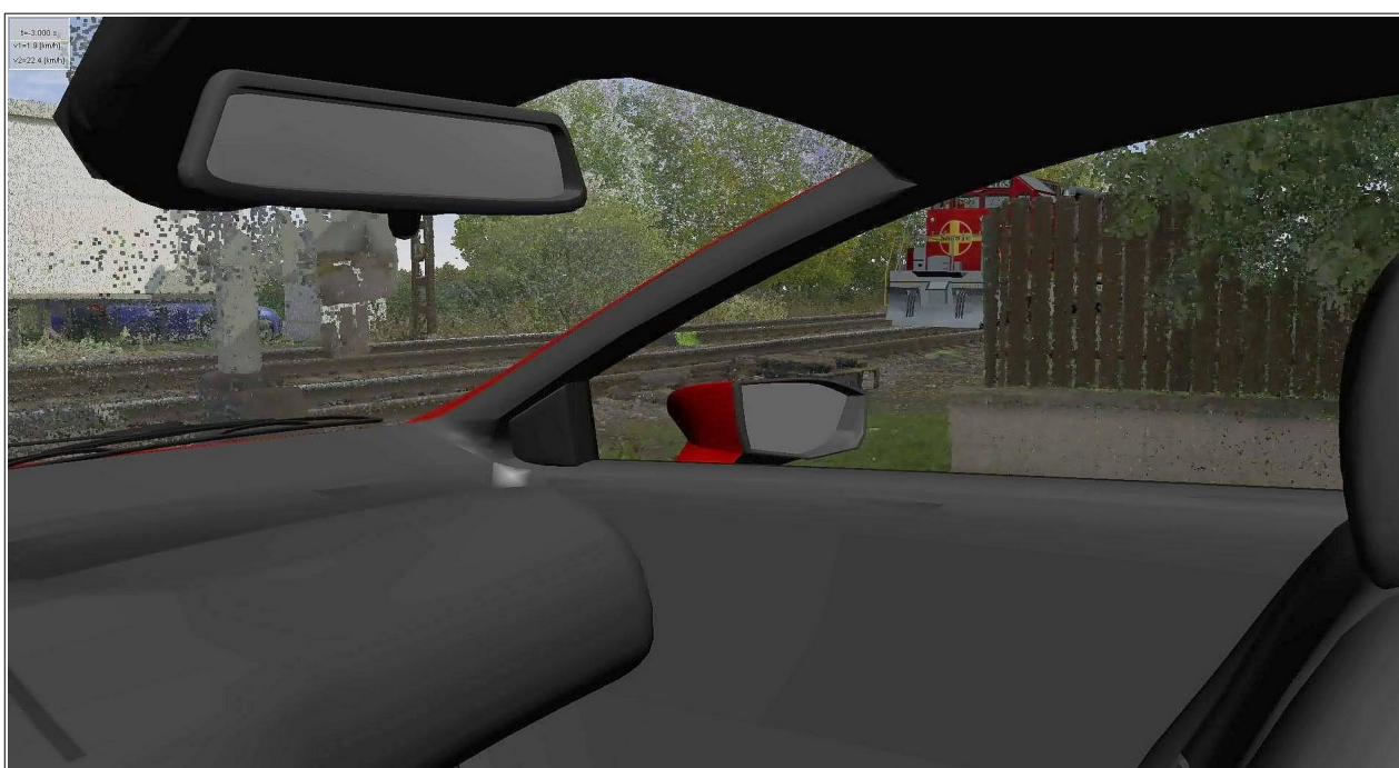
Obr. č. 5: Pomalý rozjezd, čas 3,0 s před střetnutím (tj. 0,5 s po rozjezdu) – řidič mohl vidět více než polovinu čela HDV
