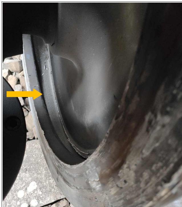
Obr. č. 2: Detail axiálního posunutí uvolněné obruče Zdroj: DI
