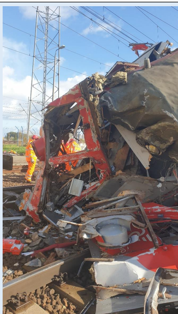
Zdjęcie 32– Skutki zdarzenia uszkodzenie e.z.t. EN57-1248 (źródło: materiał własny PKBWK)
