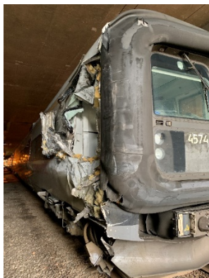
Skador på växlingsrörelsens front. Foto: ISS.
