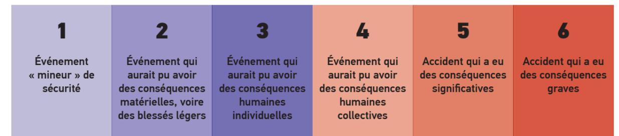
Figure 1 : Échelle de gravité pour l'évaluation des événements de sécurité ferroviaires
