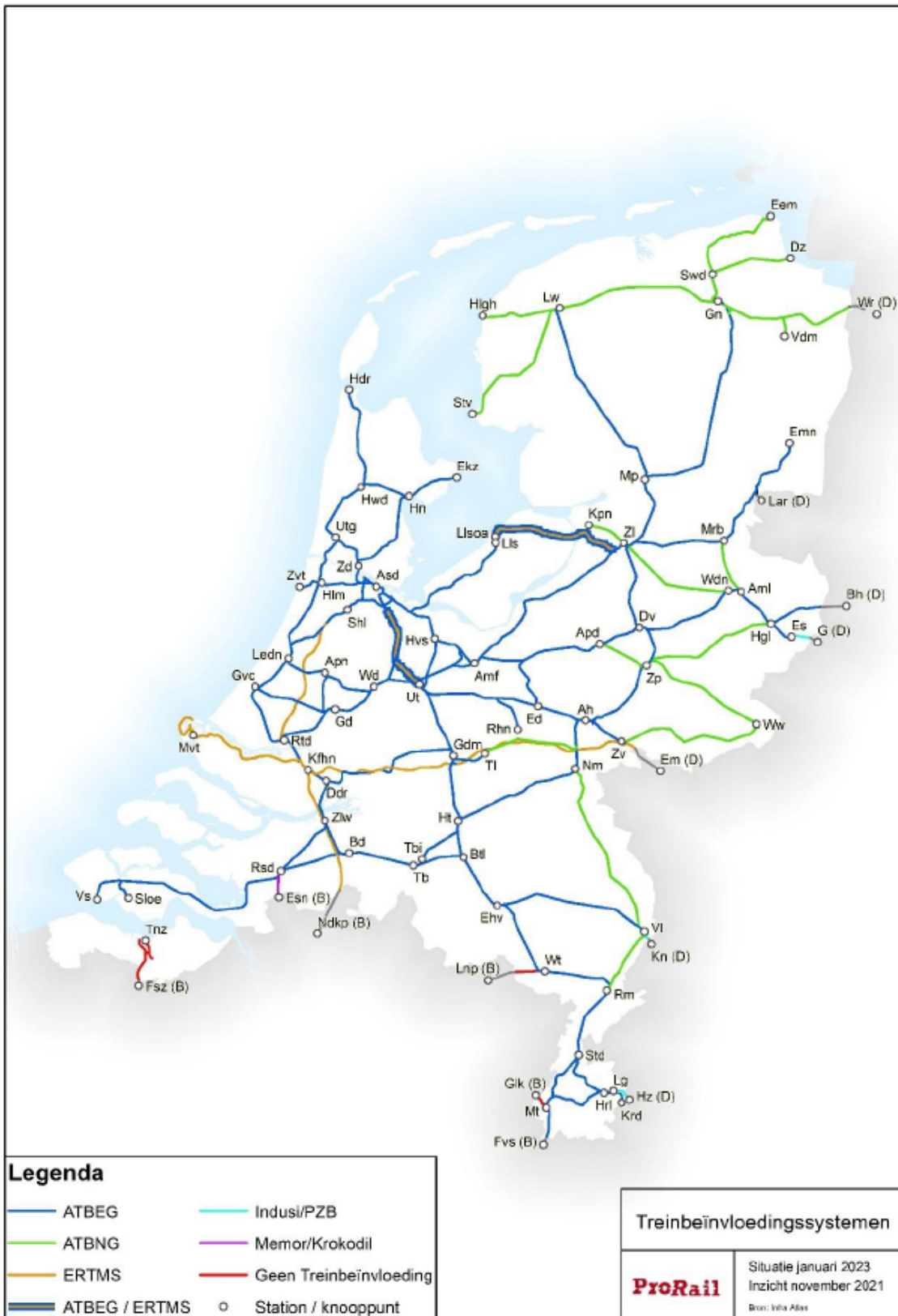
Figuur B.2: Overzichtskaart van de treinbeïnvloedingssystemen op het hoofdspoor. Uit: ProRail. Netverklaring 2023 . Versie 1.0. December 2021, Bijlage 14.
