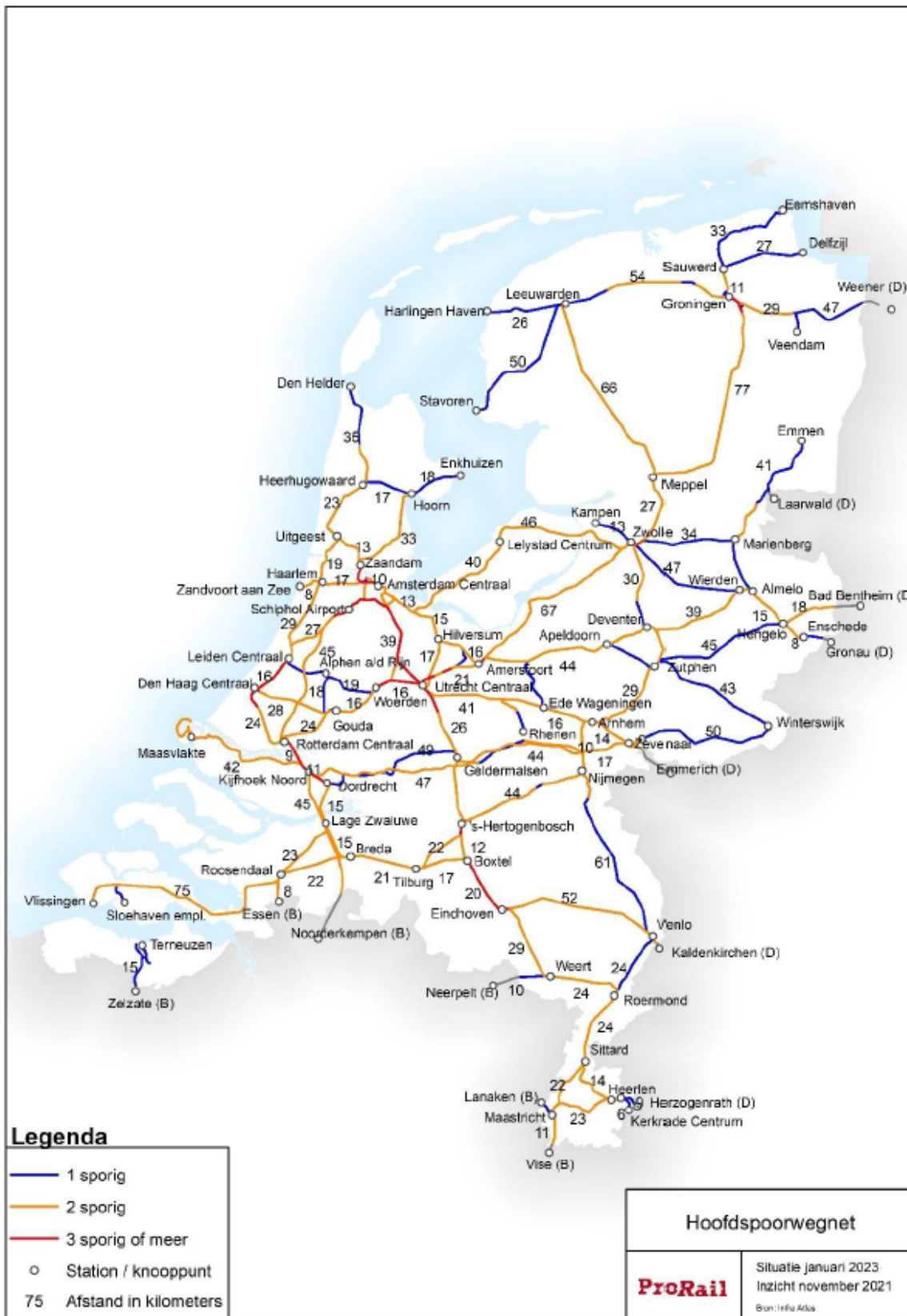
Figuur B.1: Algemene overzichtskaart met netwerkconfiguratie van het hoofdspoor. Uit: ProRail. Netverklaring 2023 . Versie 1.0. December 2021, Bijlage 1.
