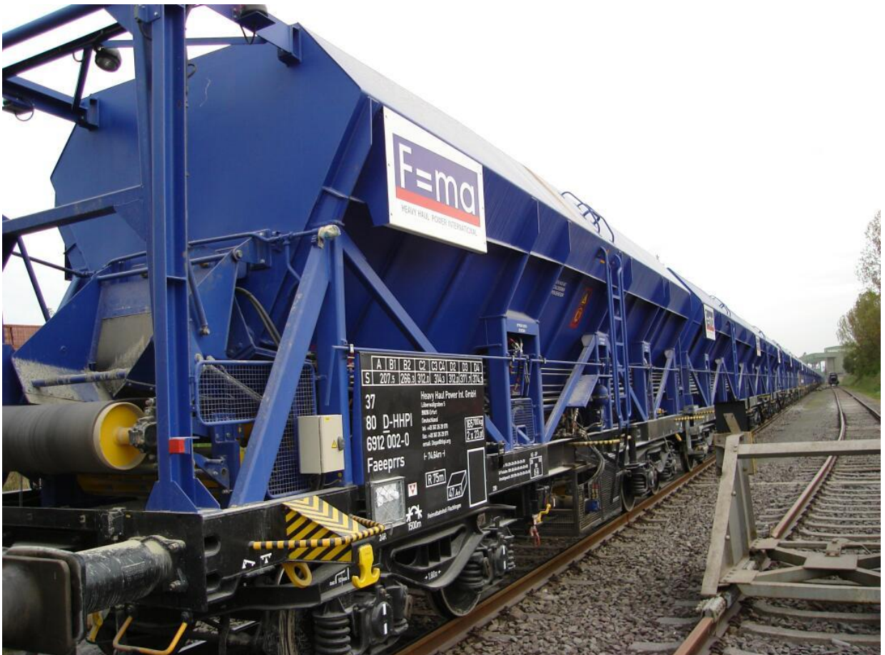
Abbildung 4: Beispiel 3 für eine Einheit bestehend aus einer Gruppe dauerhaft miteinander verbundener Elemente, die nicht einzeln betrieben werden können (Selbstentladewagen)
