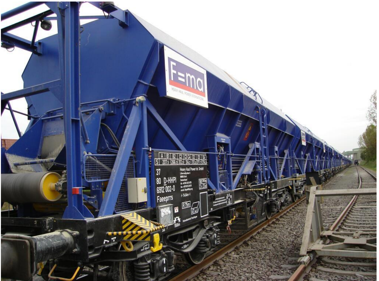
Joonis 4. Püsivalt ühendatud kahest elemendist, mida ei ole võimalik eraldi kasutada, koosnevat koosseisu hõlmava üksuse kolmas näide (isetühjenev vagun)
