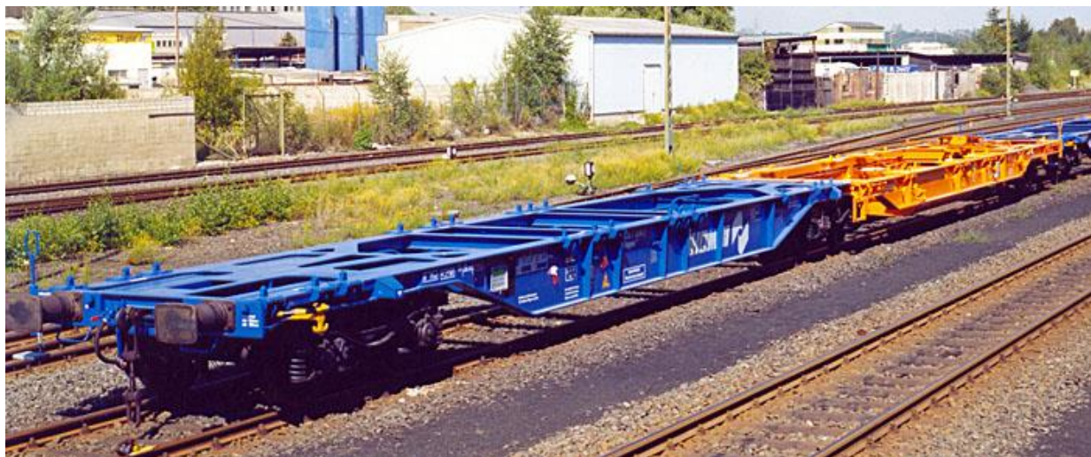
Joonis 2. Püsivalt ühendatud kahest elemendist (sinine ja oranž), mida ei ole võimalik eraldi kasutada, koosnevat koosseisu hõlmava üksuse esimene näide
