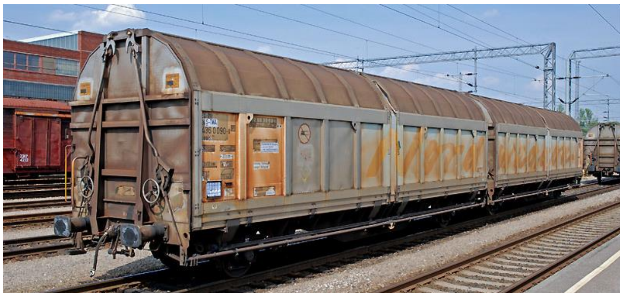
Slika 4.: Primjer 3. jedinice koja se sastoji od niza trajno međusobno povezanih elemenata, ti elementi ne mogu prometovati posebno (samoistovarni vagon)
