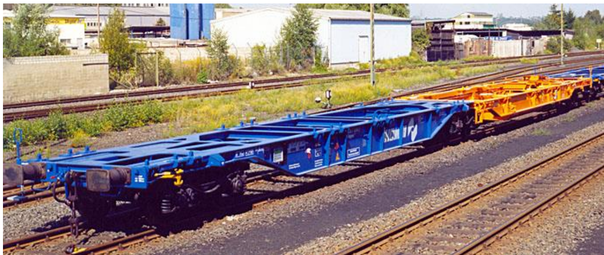
Slika 2.: Primjer 1. jedinice koja se sastoji od niza trajno međusobno povezanih dvaju elemenata (plavi i narančasti), ti elementi ne mogu zasebno prometovati (zglobni vagon)
