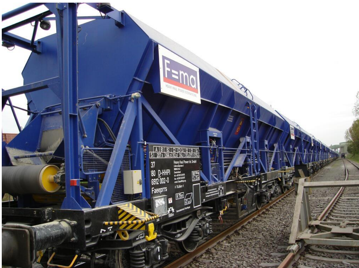
Slika 4.: Primjer 3. jedinice koja se sastoji od niza trajno međusobno povezanih elemenata, ti elementi ne mogu prometovati posebno (samoistovarni vagon)
