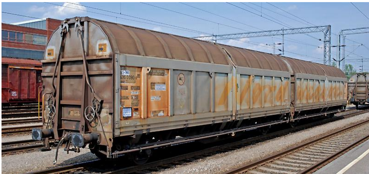
Figura 4: esempio 3 di un'unità composta di elementi permanentemente connessi e che non possono funzionare separatamente (treno a scarico automatico)
