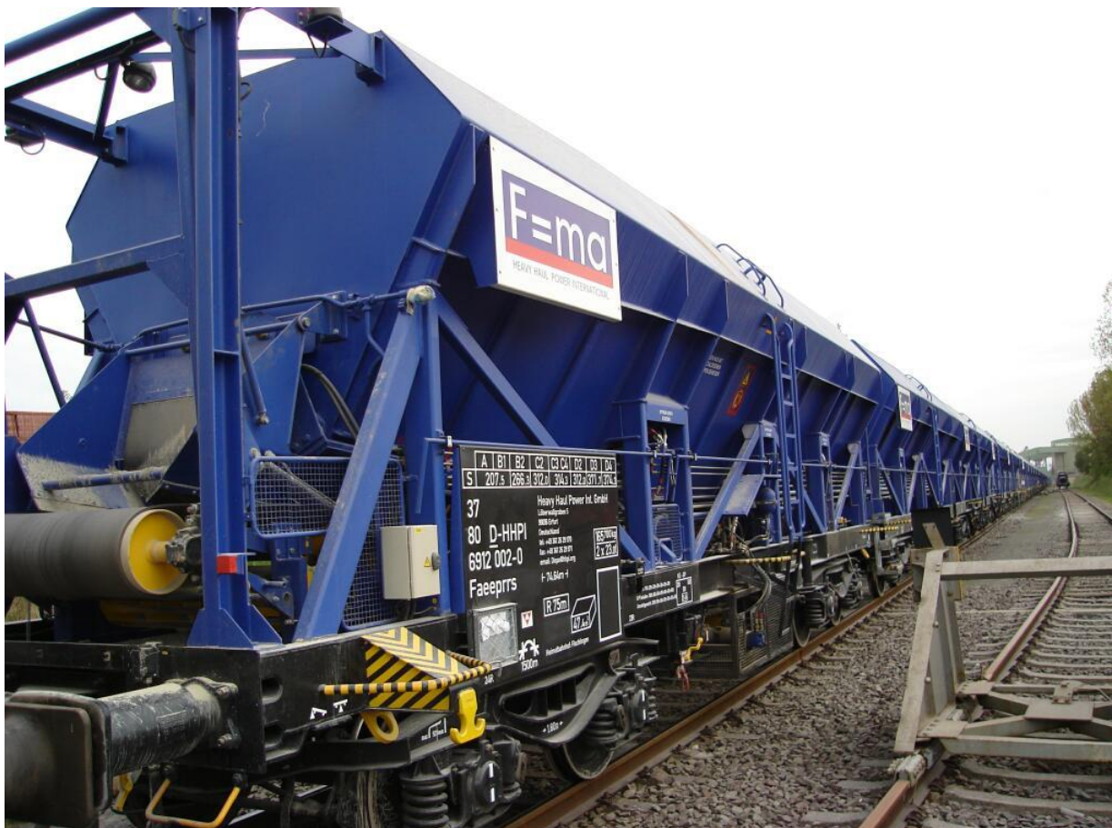
Figura 4: esempio 3 di un'unità composta di elementi permanentemente connessi e che non possono funzionare separatamente (treno a scarico automatico)
