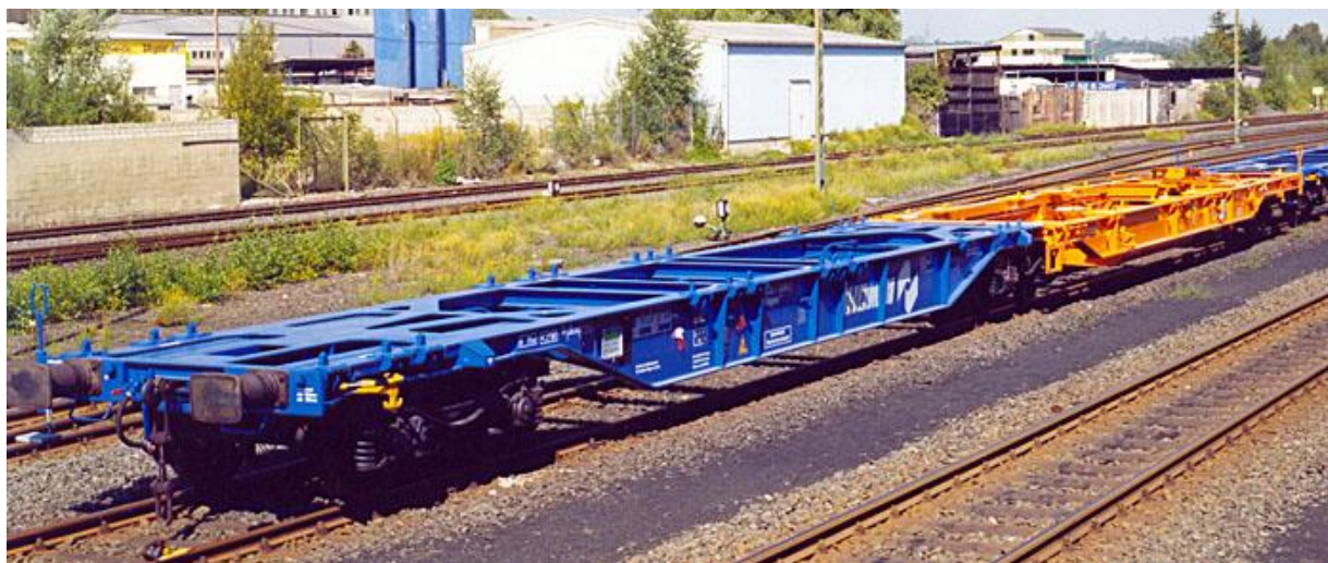
Figura 2: esempio 1 di un'unità composta di elementi permanentemente connessi (blu e arancio) e che non possono funzionare separatamente (carro articolato)
