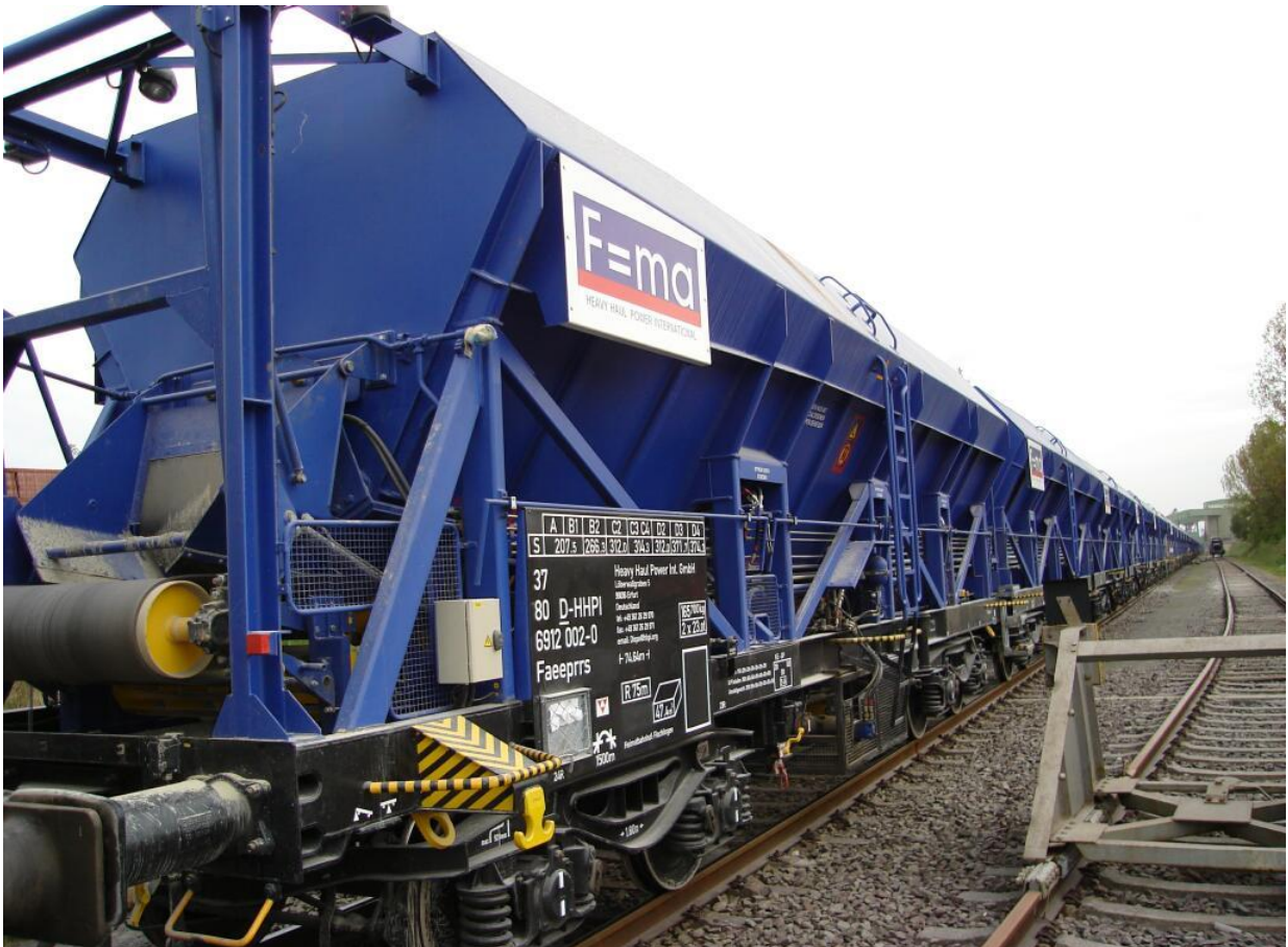
Figura 4: Exemplo 3 de uma unidade composta por dois elementos ligados de forma permanente que não podem circular / operar separadamente (comboio auto-descarregável)
