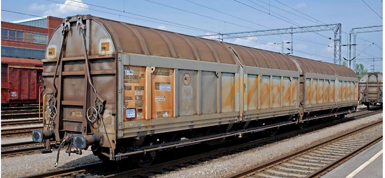
Figura 4: Exemplo 3 de uma unidade composta por dois elementos ligados de forma permanente que não podem circular / operar separadamente (comboio auto-descarregável)
