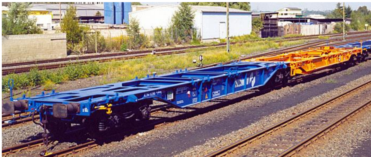
Figura 2: Exemplo 1 de uma unidade composta por dois elementos (azul e laranja) ligados de forma permanente (“composição indivisível”) que não podem circular / operar separadamente (vagão articulado)
