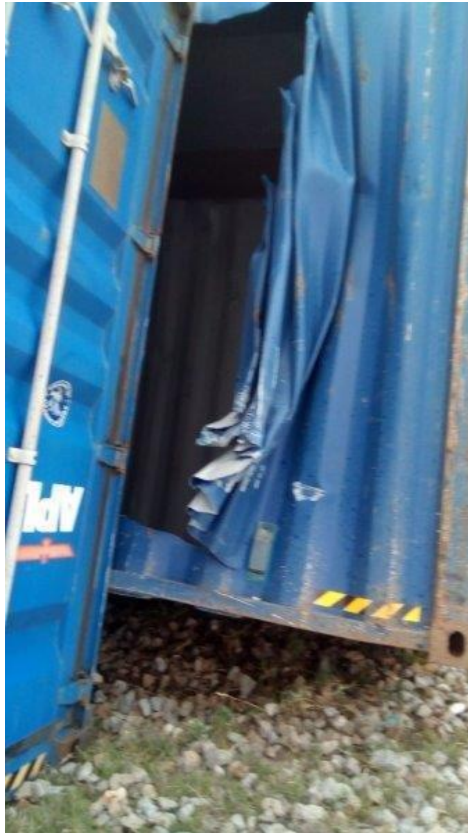
Slika 7. – Oštećenja na kontejneru (izvor slike: AIN )
