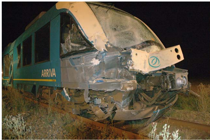
Figur 3. Beskadigelserne på togets front og side
