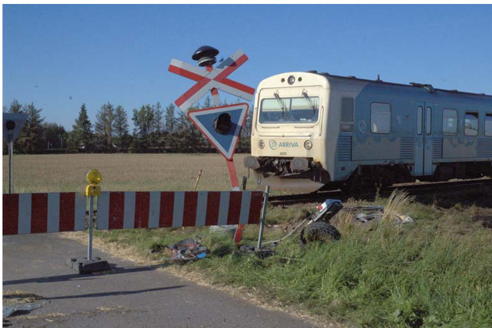
Figur 6. Den beskadigede overkørsel , bemærk teknikskabet til højre i billedet lige under togets bogie
