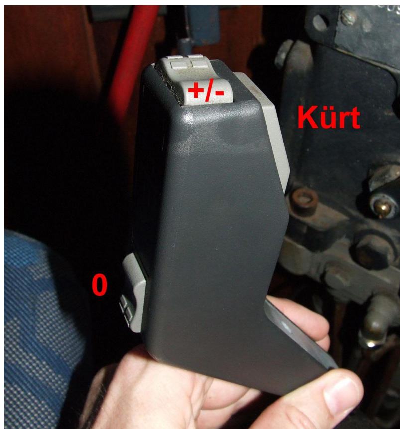
4. ábra: a motorkocsi menetkapcsolója
