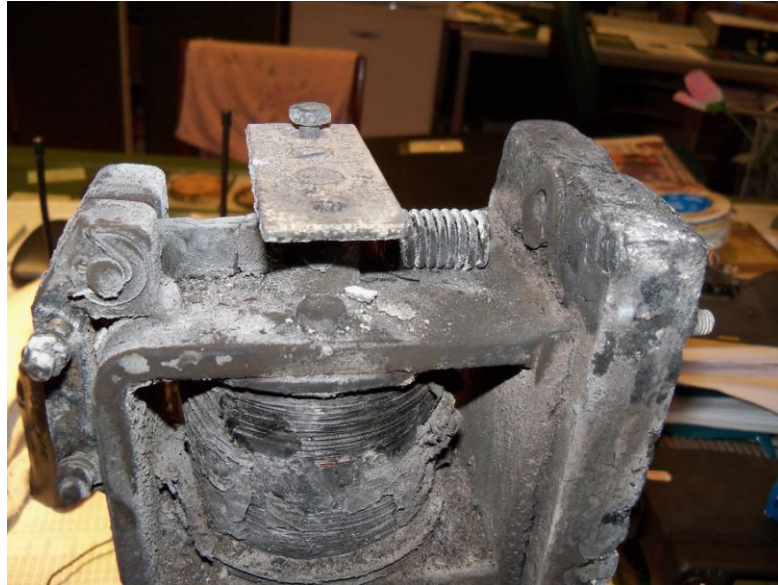
8. ábra Az eltörött csavar az egységkapcsolón
