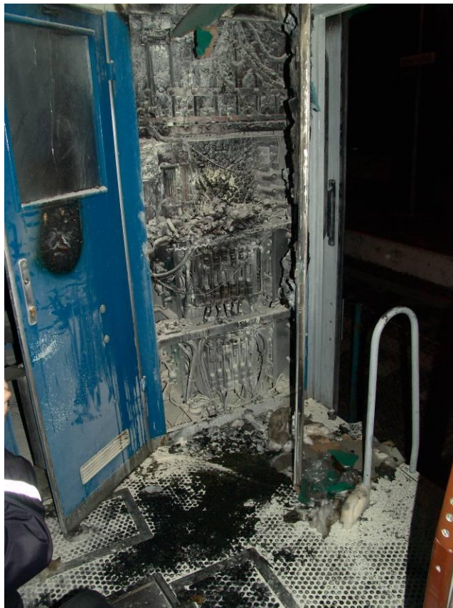
3. ábra A kiégett készülékszekrény
