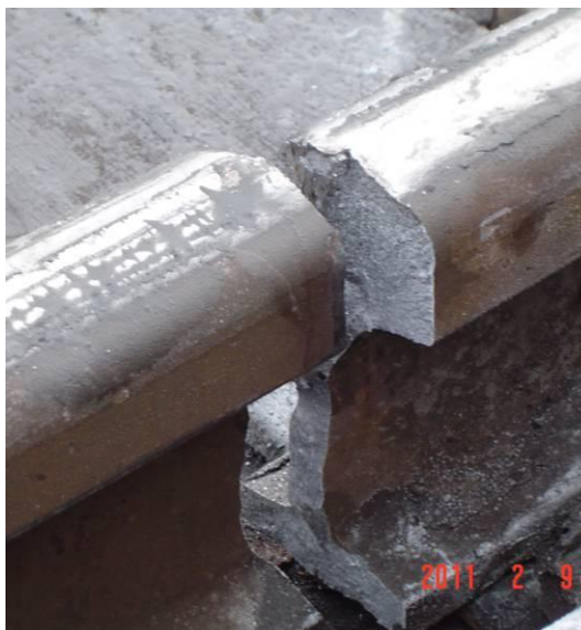
5. ábra A 14 sz. váltó törés felülete (forrás: VBO)
