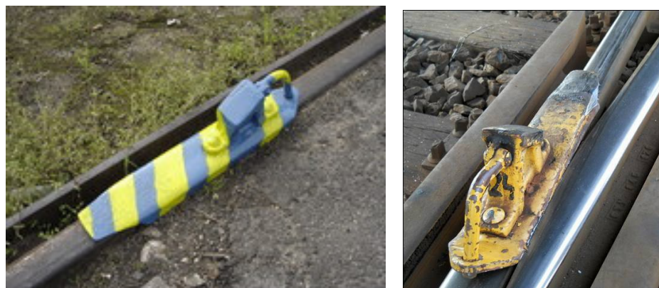
9. ábra: Friss festésű rögzítősaru és a helyszínen talált kopott saru
