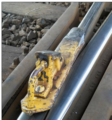
6. ábra: A kitérőben megszorult féksaru
