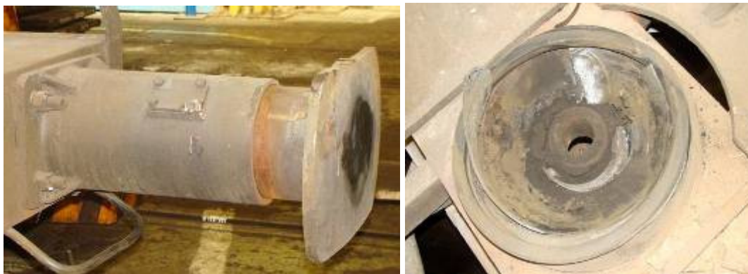
12. ábra: Kenetlen ütköző és a sérült forgótányér
