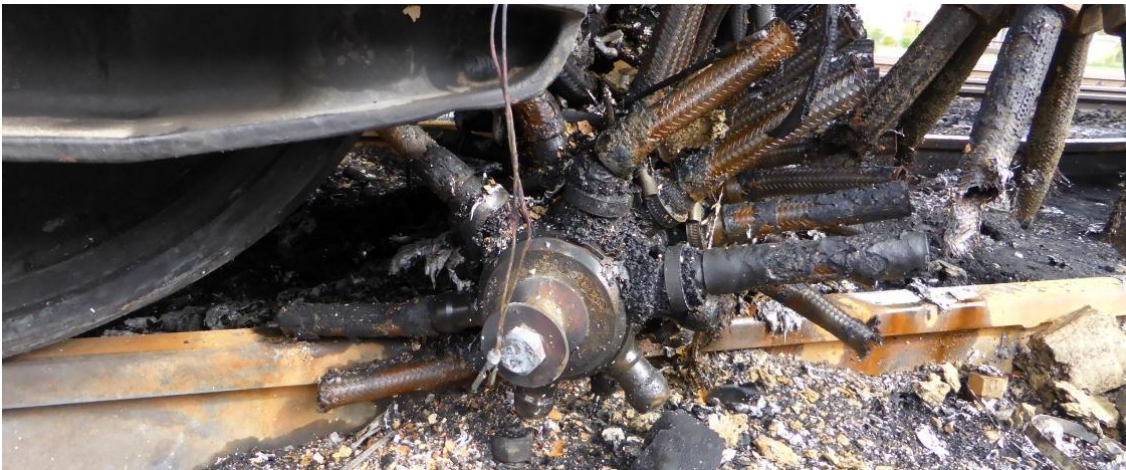
Abbildung 16: Vorfalldauer Lagerchenkel der Horizontalbürste (Quelle IM)
