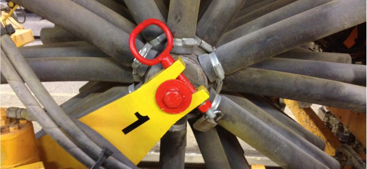
Abbildung 27: Sicherung einer Reservebürste durch Sicherungsbolzen mit Schloss (Quelle VK)
