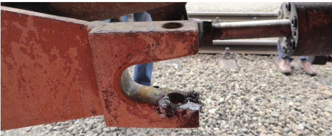
Abbildung 17: Vorfalldauer Lagerung der Horizontalbürste (Quelle IM)
