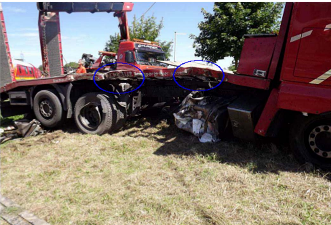
Abbildung 8: Abdrücke der Puffer am LKW (Quelle PI Sattledt)
