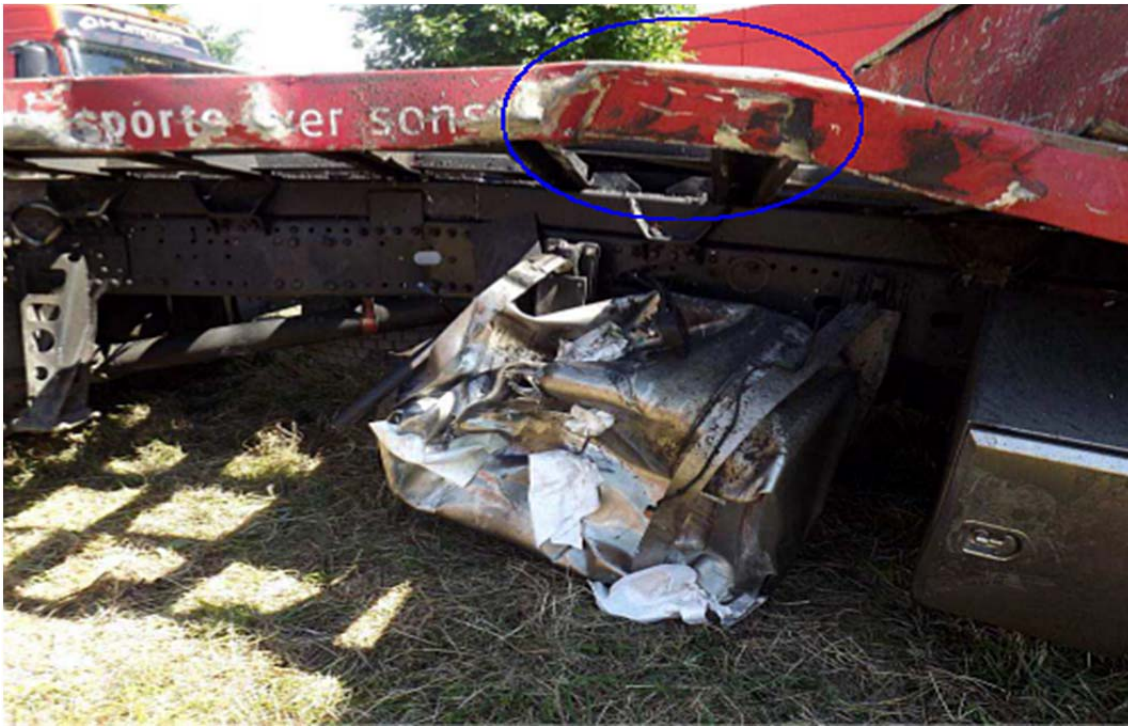
Abbildung 9: Tank und Abdrücke der Puffer im Detail (Quelle PI Sattledt)
