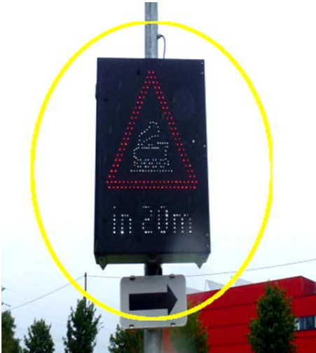
Abbildung 13: ISIS-Wechselverkehrszeichen für Straßenfahrzeuge (Quelle SUB)
