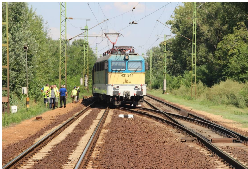
3. ábra: a helytelen állásban álló 3. sz. váltó előtt megállt IC 560 sz. vonat
