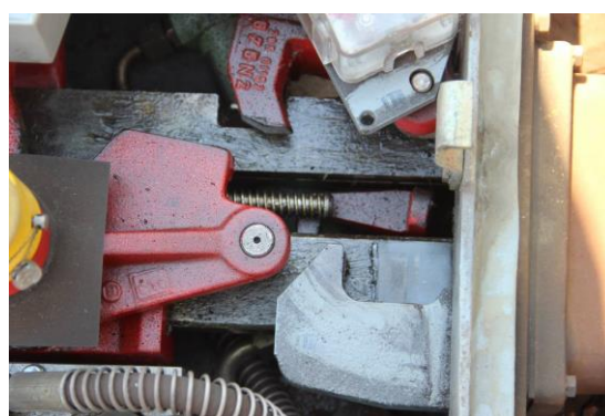
10. ábra: a végállás nélküli 1. sz. váltó állása a baleset idején
