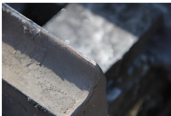
9. ábra: az 560-1 sz. vonat által okozott sérülés az 1. sz. váltó végállás nélküli csúcssínjén
