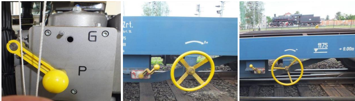
6. ábra: A mozdony és a kisiklott kocsi vonatnemváltója személyvonati állásban, a második védőkocsi vonatnemváltója tehervonati állásban volt
