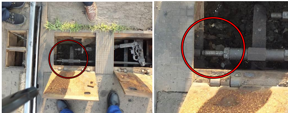
12. ábra: a balesetben érintett váltó törött vonórúdja
