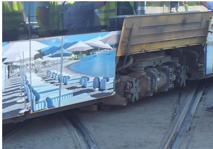
6. ábra: a villamos harmadik, siklott forgóváza
