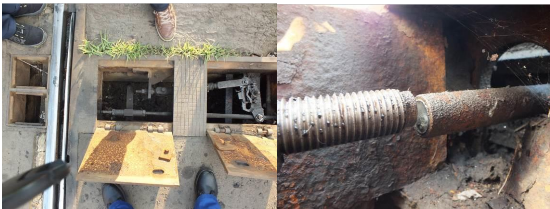
5. ábra: a rövid vonórúd törése
