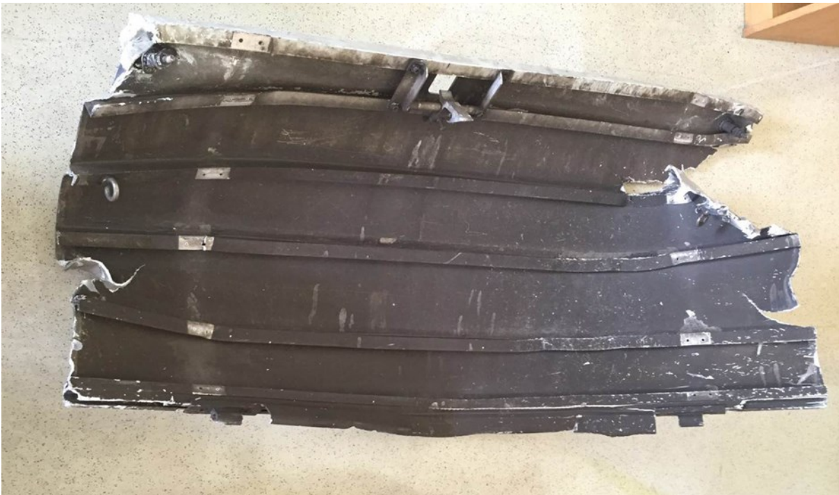
Abbildung 6: Beschädigte Grauwasserschürze Innenansicht (Quelle ÖBB PV AG)
