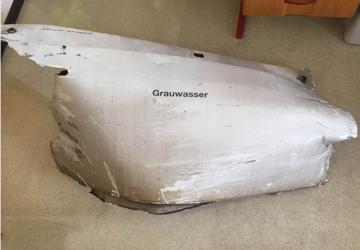
Abbildung 5: Beschädigte Grauwasserschürze Außenansicht (Quelle ÖBB PV AG)
