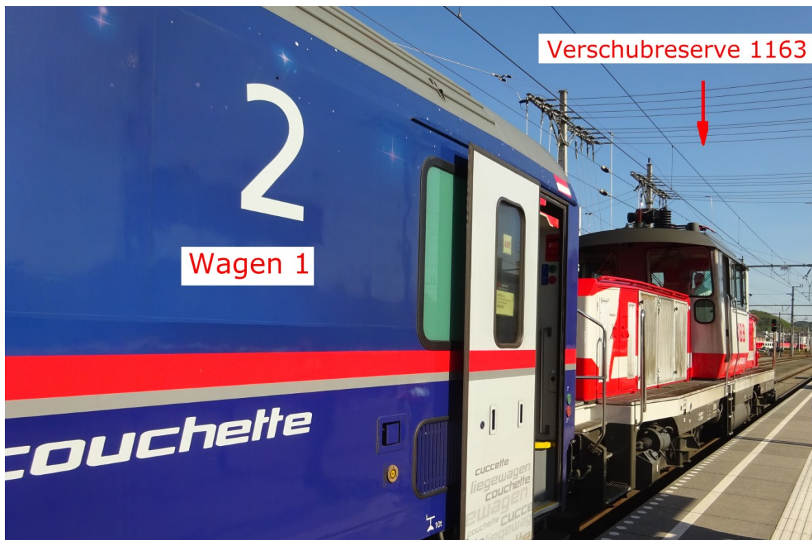
Abbildung 9: Vershubreserve 1163 mit geschobenem Vershubteil
