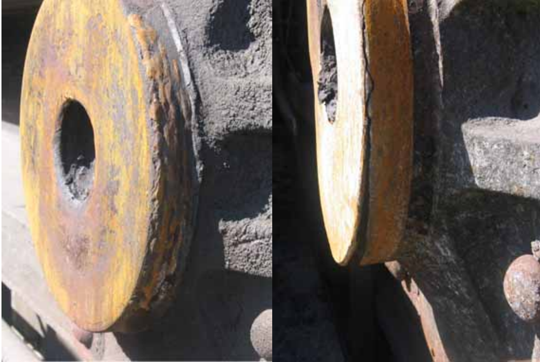
Kuva 20. Vaunun puoleiseen telikeskiöön oli hitsaamalla lisätty uusi liukupinta ja joissakin keskiöissä se oli osaksi irronnut.
