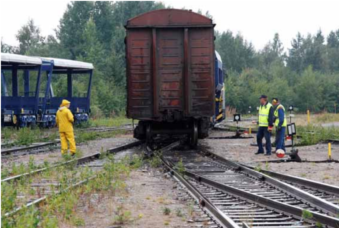
Kuva 23. Onnettomuudessa kaatuneiden 17. ja 18.vaunun koeajo.
