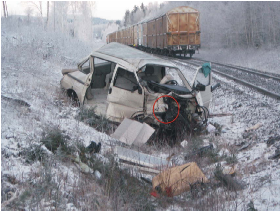
Kuva 2. Pakettiauto sinkoutui ratapenkereelle 20 metrin päähän törmäyskohdasta. Veturin vasemman puskimen osumakohta on merkitty punaisella ympyrällä (kuva Keski-Suomen pelastuslaitos).
