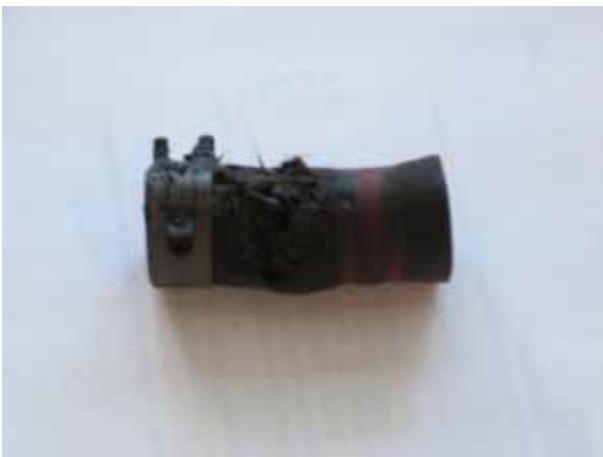
Lähes poikki oleva letku kampikammion tuuletusputkesta
