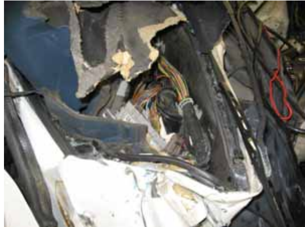
Moottorin testausta varten korjattu johtosarja
