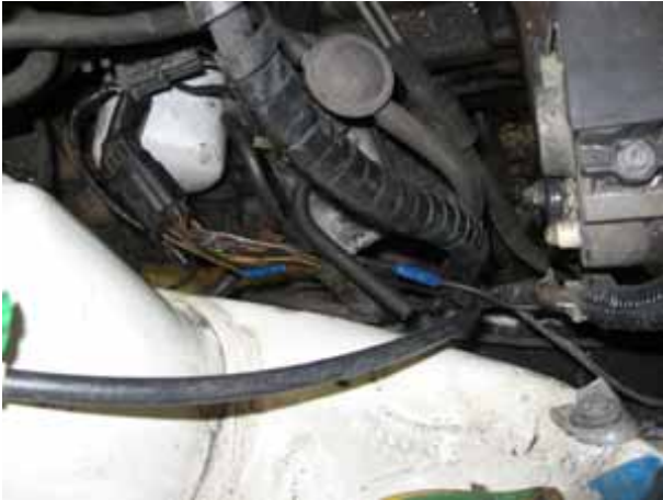
Moottorin testausta varten korjattu johtosarja
