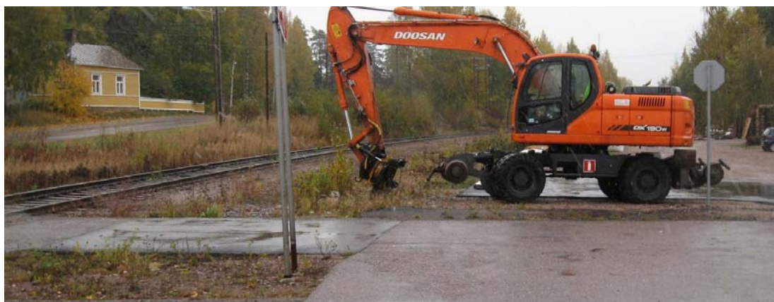
Kuva 7. Rautakaupan pihalle pysäköity henkilöautoa korkeampi ajoneuvo haittaa junan havaitsemista.
