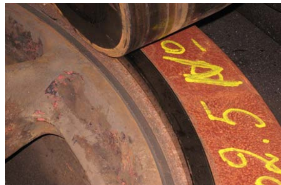
après refroidissement sertissage du cercle agrafe par le galet presseur
