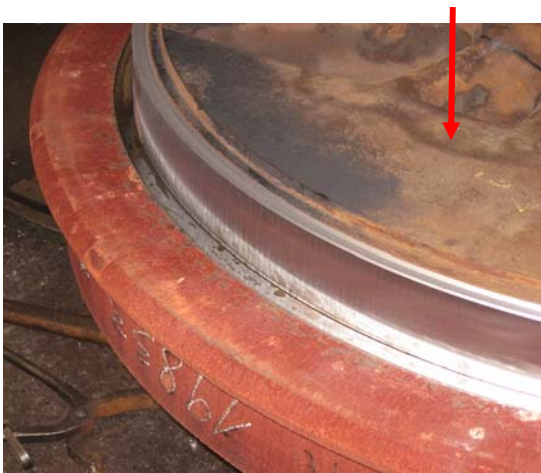
introduction de l'essieu dans le bandage
