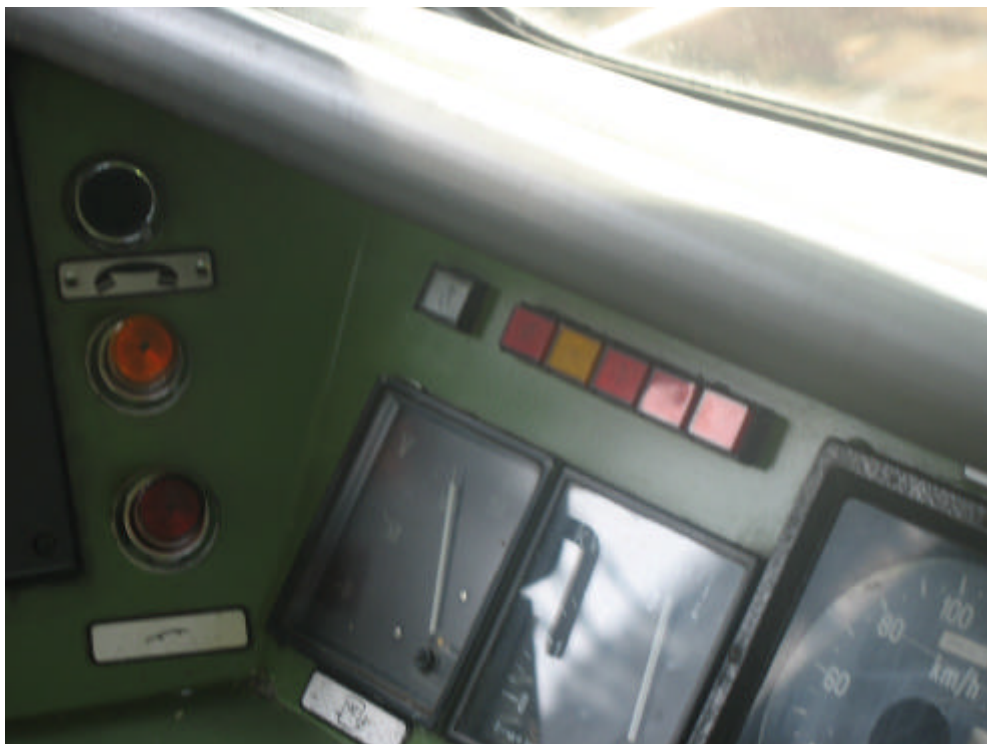
Figuur 29 : Geopende deur nr. 4 en gedoofde witte lamp stuurpost, MS 399.
