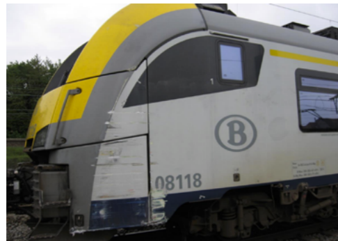
Photo des légers dégâts sur l'AM 08118 échappée
