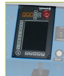
Illustration : GSM-R dans la cabine de conduite d'une AM08.
