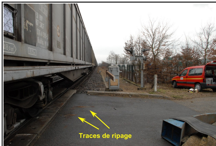
Figure 29 : Vue des traces de ripage sur la chaussée
