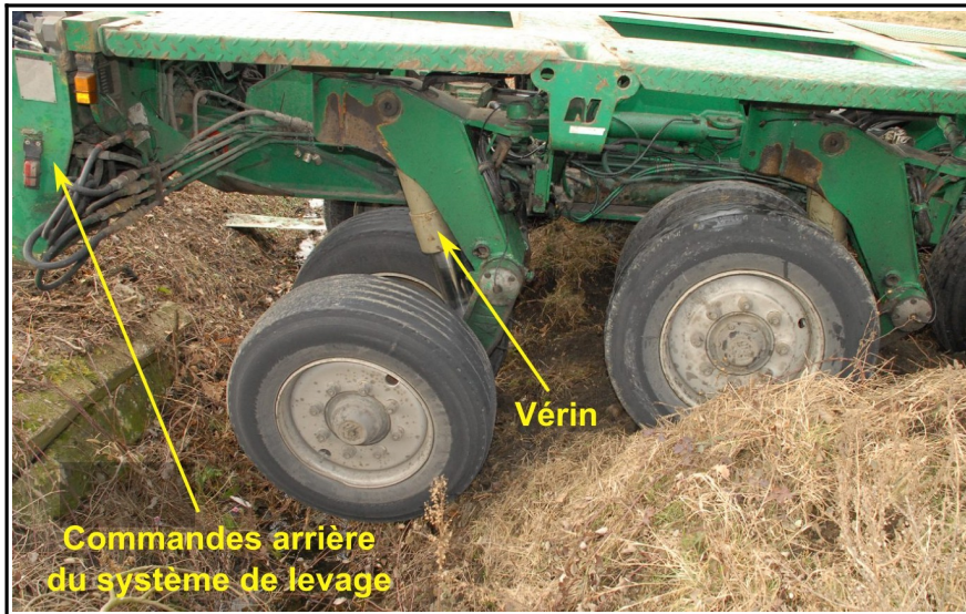
Figure 15 : Vue d'un vérin assurant le levage des essieux
