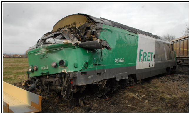
Figure 11 : Locomotive BB 467465 de tête, décapitée
