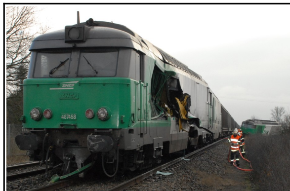
Figure 12 : Locomotive BB 467458 en seconde position, déraillée et éventrée
