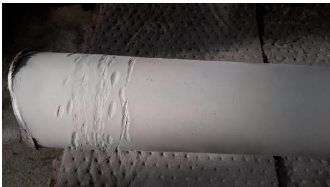
Figuur 83 : Wielas B geverfd voor magnetisch onderzoek, kan van breukoppervlak
