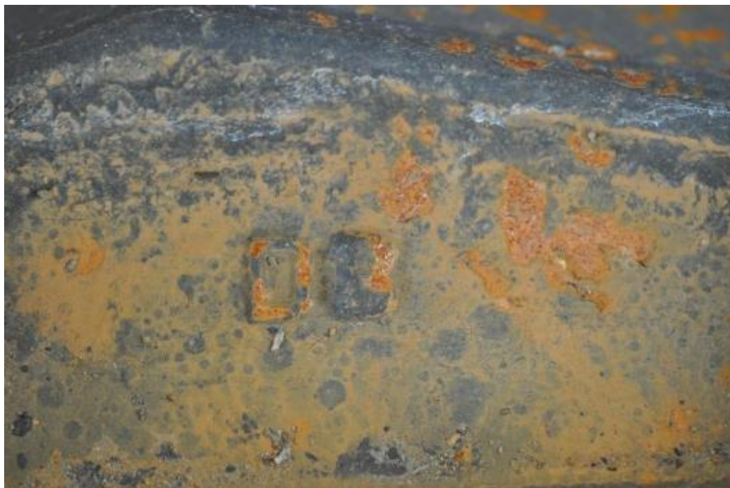
Figuur 7 : Merk op wielasbus van wiel A
