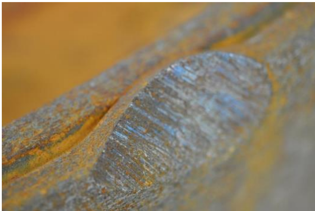
Figuur 15 : Slag van ongeveer 50 mm lang op de buitenkant van de wiel A
