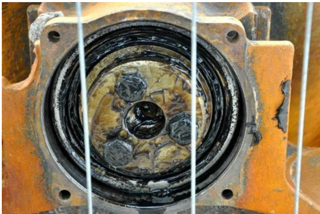
Figuur 67 : Uitzicht van binnendeel van wielasbus van wiel B na opening van de deksel
