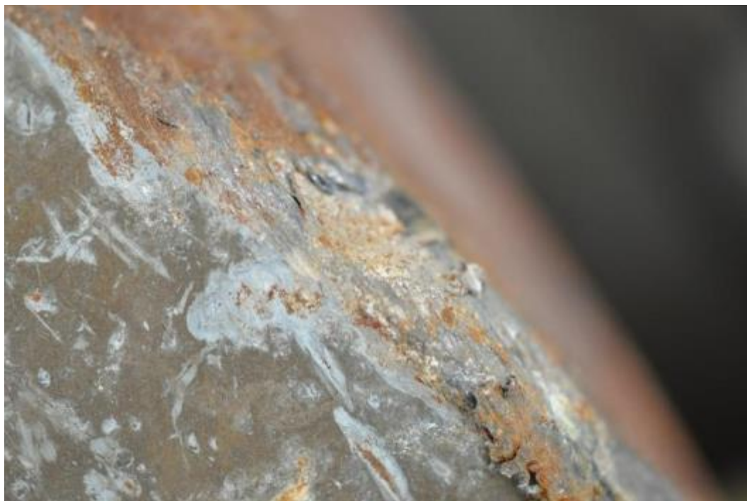
Figuur 45 : Detail van laterale vlak van wielas dicht van het breukoppervlak aan kant B
