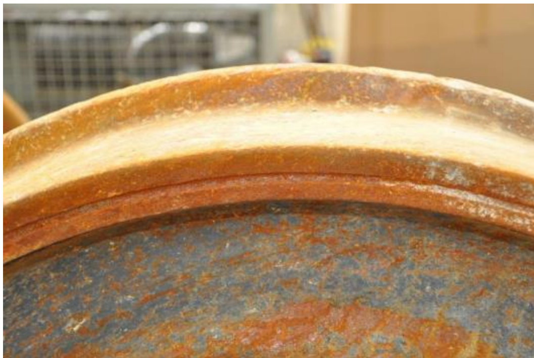
Figuur 51 : Sleetgroef van wiel B
