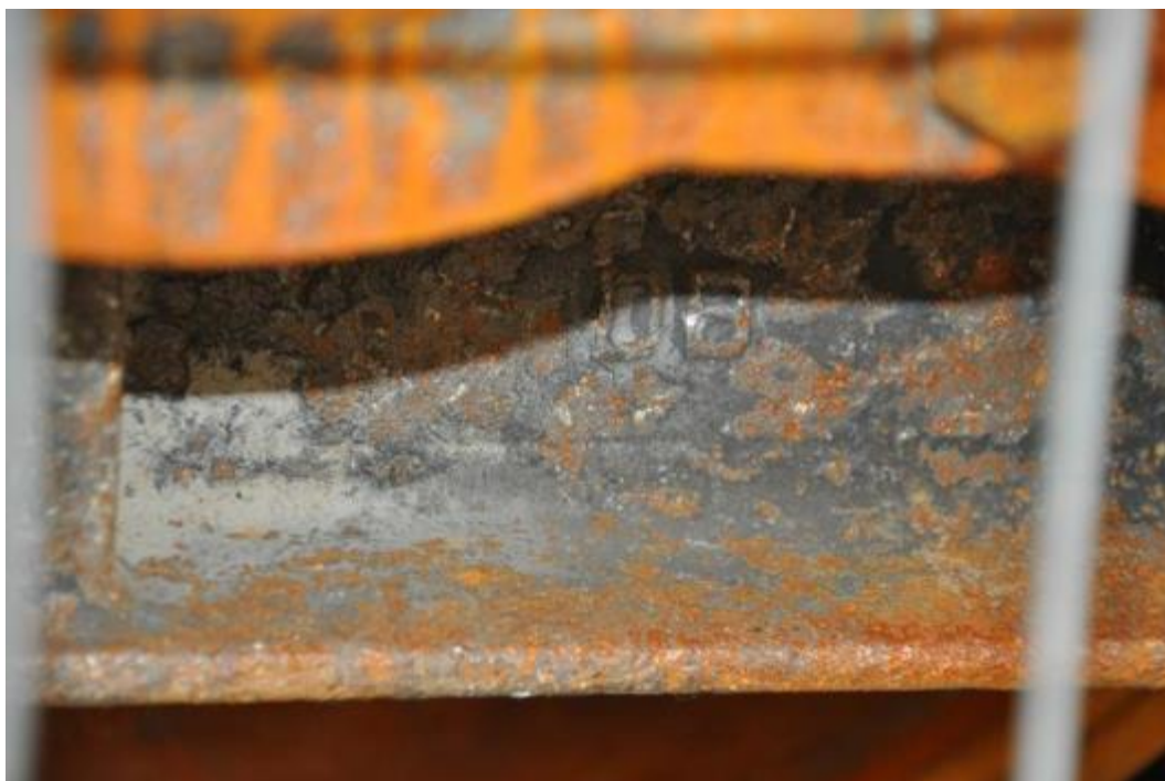
Figuur 64 : Merk op de wielasbus van wiel B
