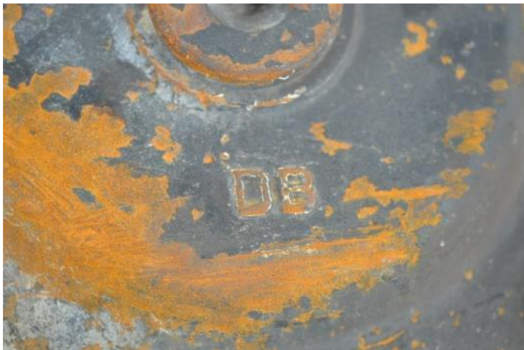
Figuur 9 : Merk op wielasbus van wiel A
