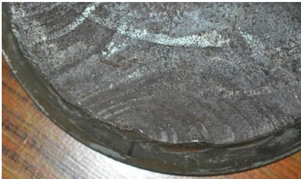
Figuur 102 : Detail van de aanzetpunt van breuk aan de kant A
