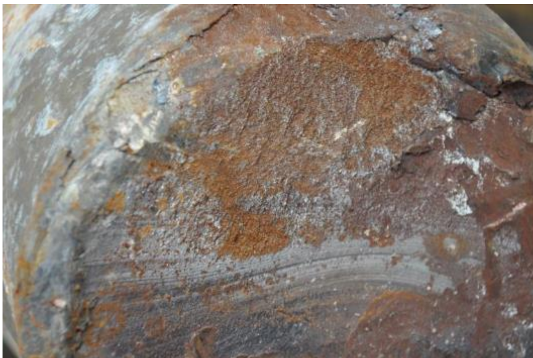
Figuur 34 : Breukoppervlak van kant B
