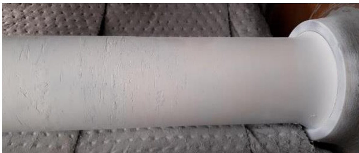
Figuur 81 : Wielas B geverfd voor magnetisch onderzoek, kant van wiel B
