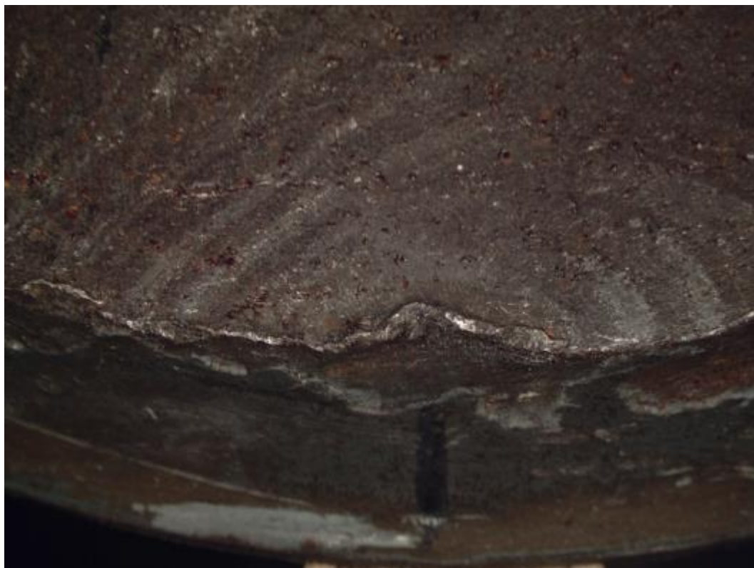
Figuur 104 : Detail van de aanzetpunt van breuk aan de kant A
