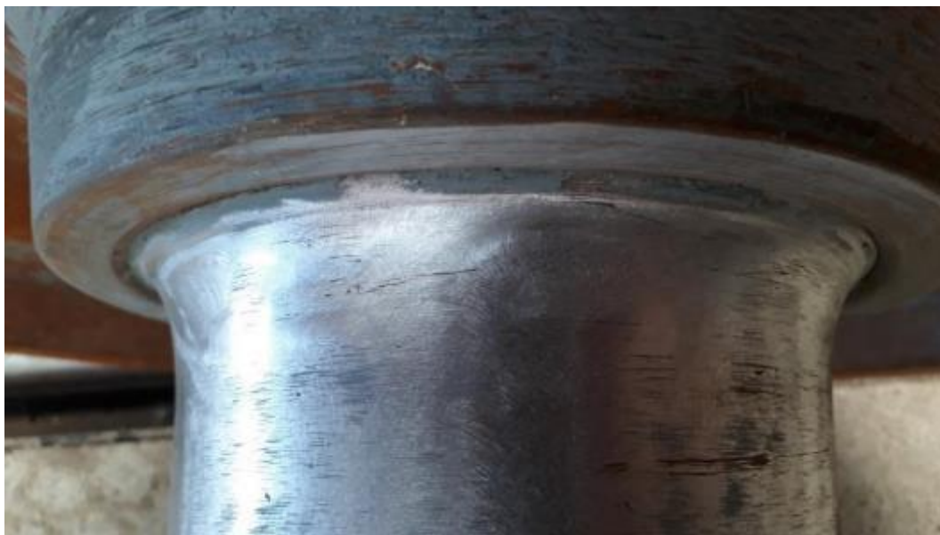
Figuur 71 : Uitzicht van wielas na schuren, kant van wiel B
