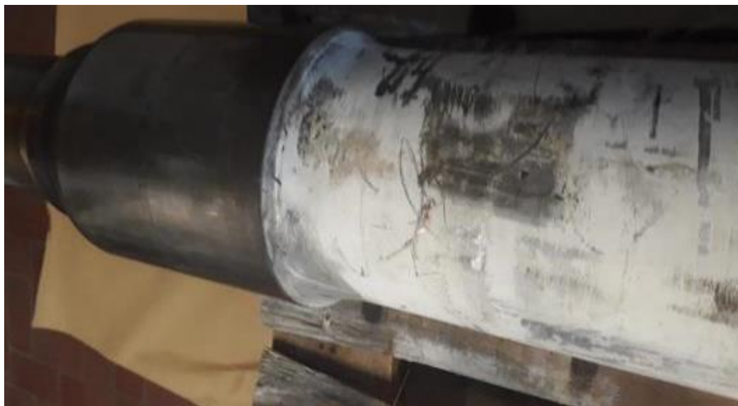
Figuur 88 : Uitzicht van asschacht en wielnaafzitting van wielas B na demontage
