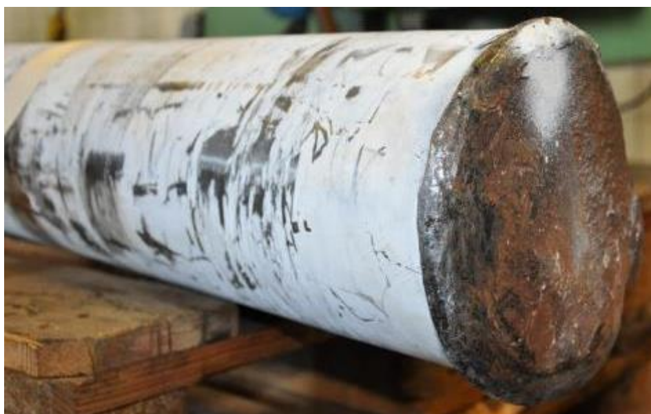
Figuur 97 : Uitzicht van breukoppervlak B van wielas
