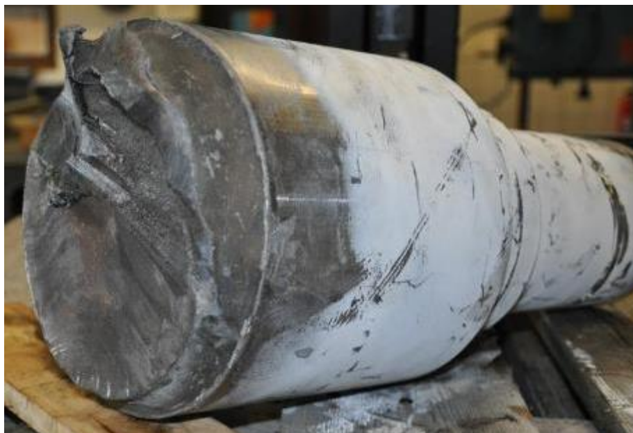
Figuur 92 : Generale uitzicht van wielas A na magnetisch onderzoek
