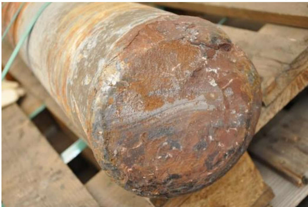
Figuur 33 : Breukoppervlak van kant B
