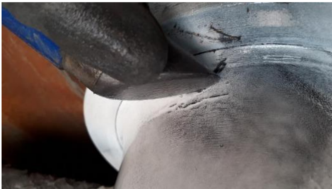
Figuur 84 : Indicatie van +/- 30 mm met permanente magneet
