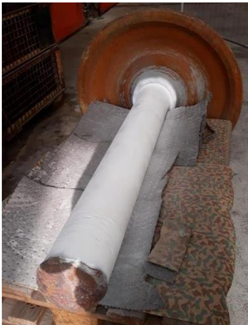
Figuur 80 : Wielas B geverfd voor magnetisch onderzoek
