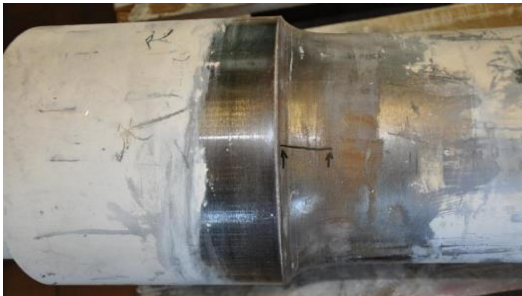
Figuur 98 : Detail van de indicatie in straal tussen wielnaafzitting en asschacht van wielas B
