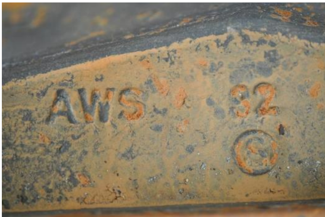
Figuur 6 : Merken op wielasbus van wiel A
