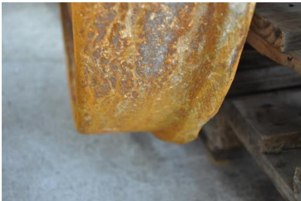
Figuur 48 : Beschadiging van kraag van wiel B
