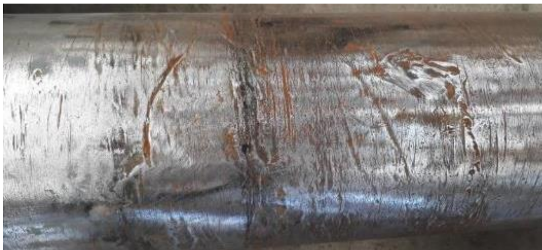
Figuur 73 : Uitzicht van wielas na schuren, middendeel
