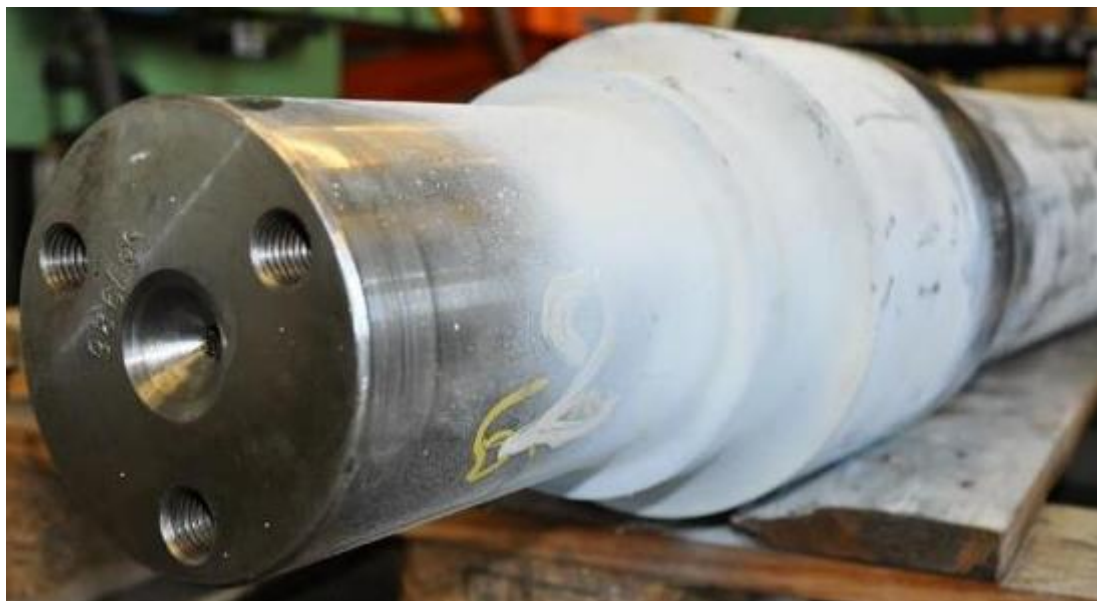
Figuur 94 : Uitzicht van astap en wielnaafzitting van wielas B na magnetisch onderzoek
