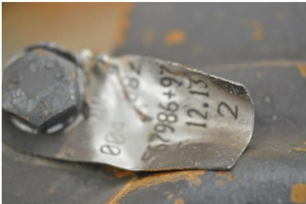
Figuur 5 : Identificatieplaat op wielasbus van wiel A
