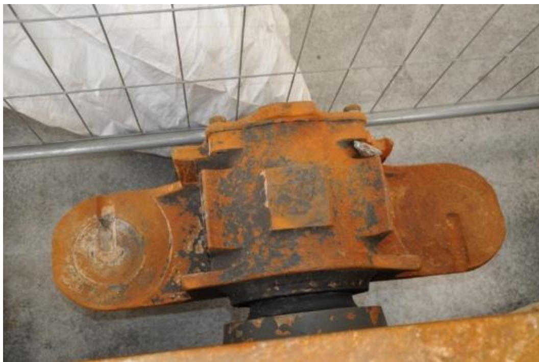
Figuur 42 : Bovenkant van wialasbus B
