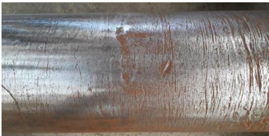
Figuur 75 : Uitzicht van wielas na schuren, middendeel
