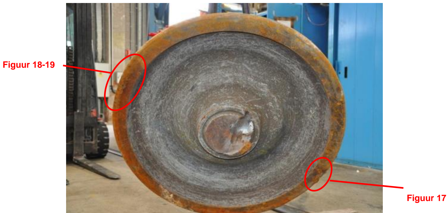
Figuur 4 : Generale uitzicht van de wiel A, binnendeel
