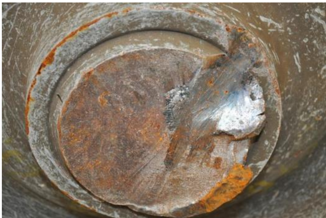
Figuur 10 : Uitzicht van breukoppervlak aan de kant van de wiel A
