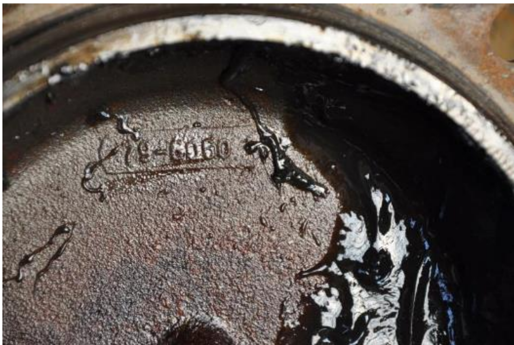
Figuur 29 : Merk op de deksel van wielasbus van wiel A
