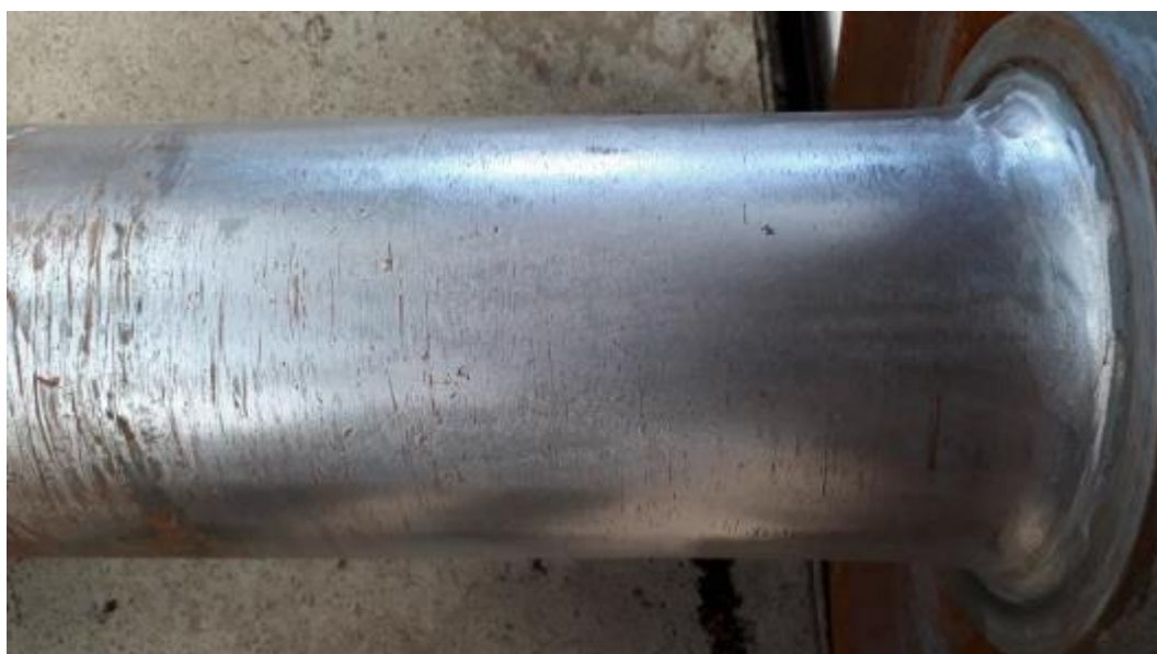
Figuur 72 : Uitzicht van wielas na schuren, kant van wiel B
