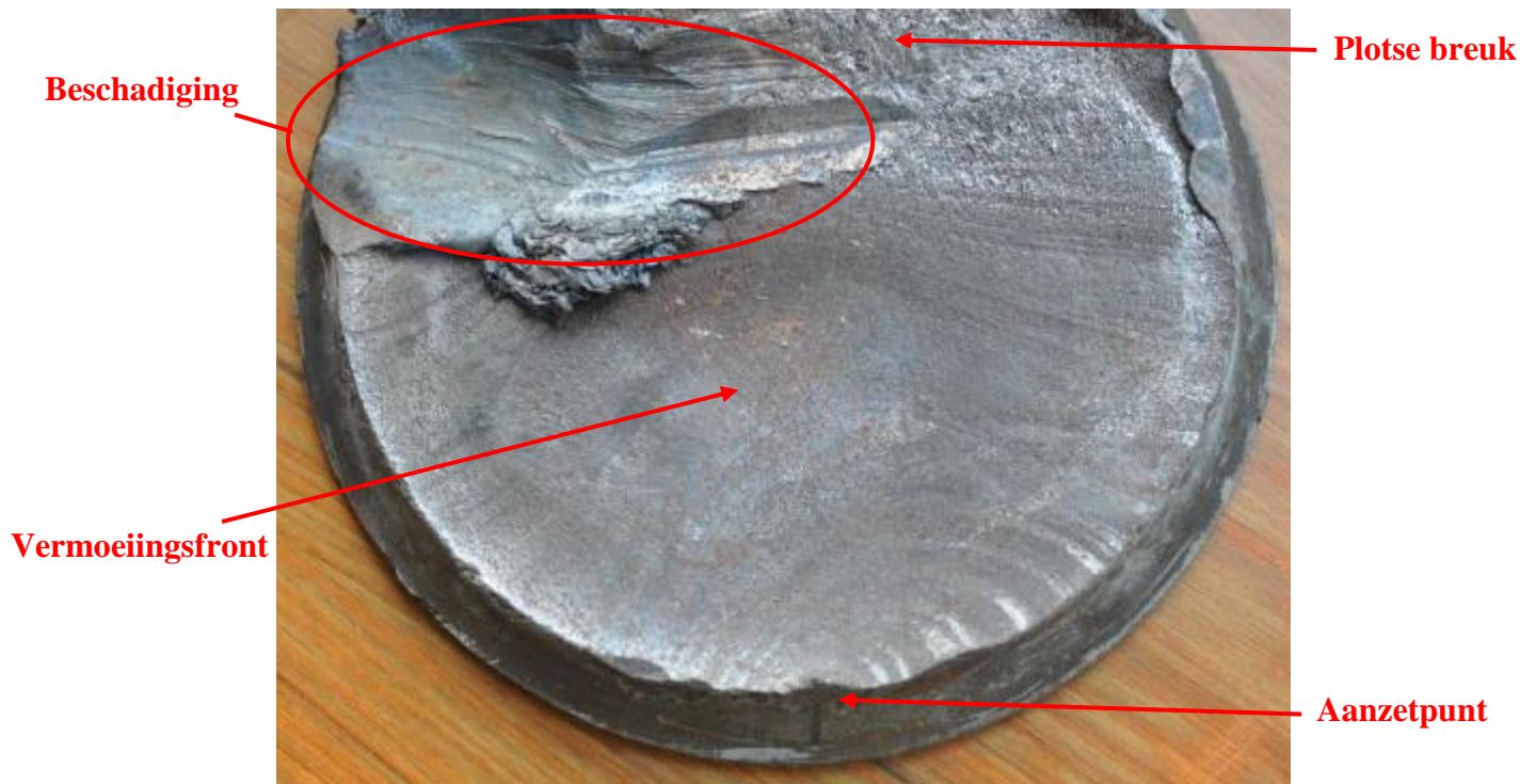
Figuur 100 : Generale uitzicht van breukoppervlak A
