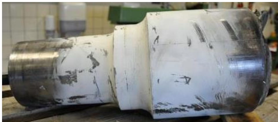
Figuur 90 : Generale uitzicht van wielas A na magnetisch onderzoek
