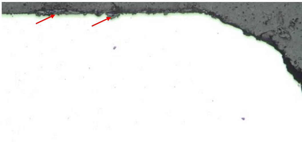
Figuur 105 : Corrosie aan wielnaafzitting op microsneede 1.1
