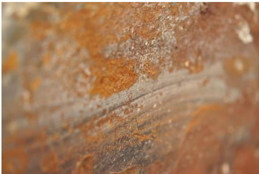
Figuur 46 : Detail van breukoppervlak aan kant B
