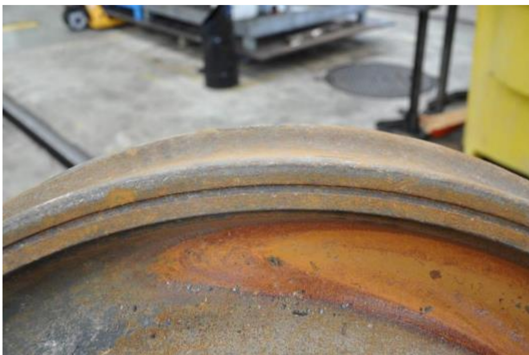
Figuur 22 : Sleetgroef van wiel A, binnendeel van wiel
