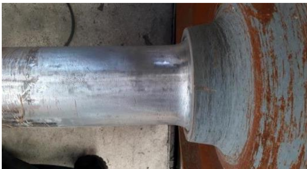
Figuur 70 : Uitzicht van wielas na schuren, kant van wiel B
