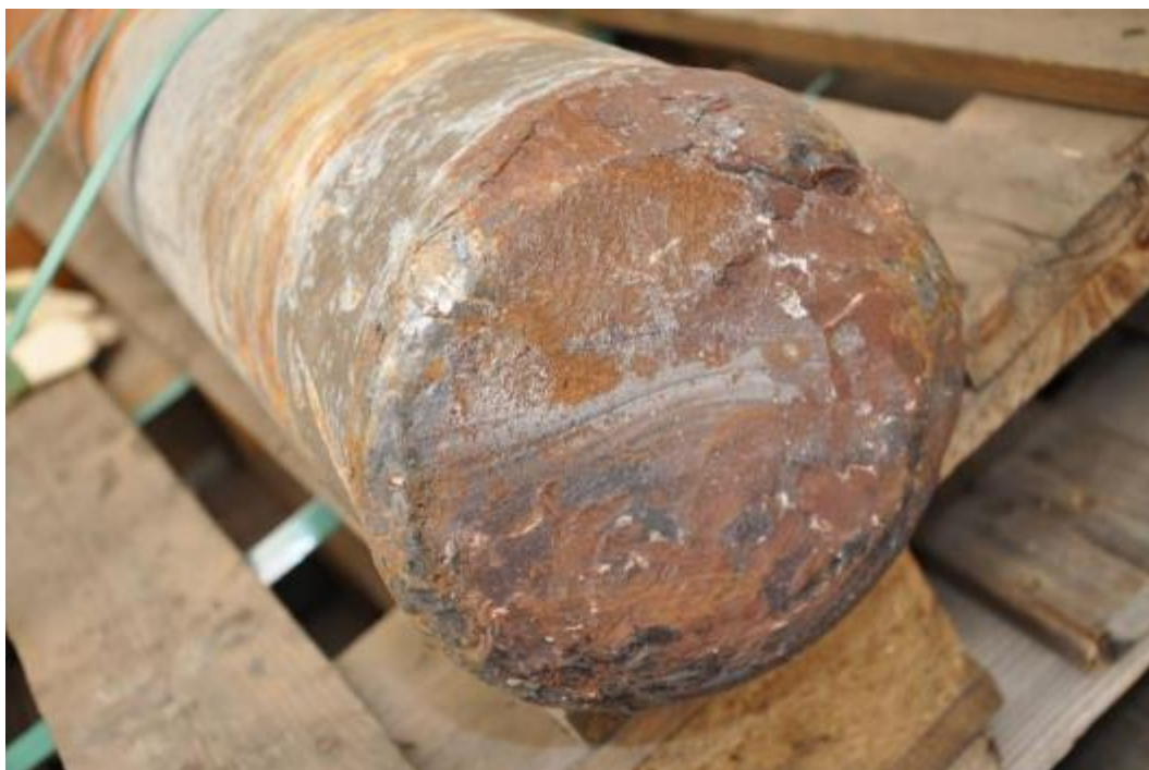
Figuur 32 : Breukoppervlak van kant B
