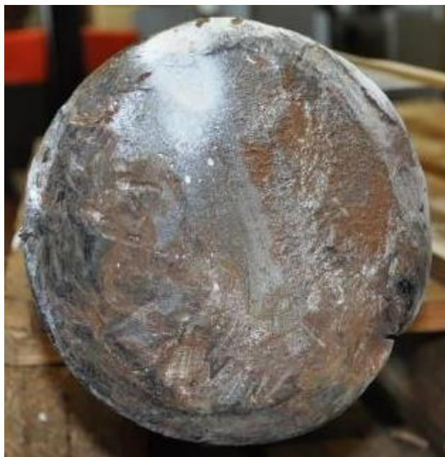
Figuur 96 : Uitzicht van breukoppervlak B van wielas
