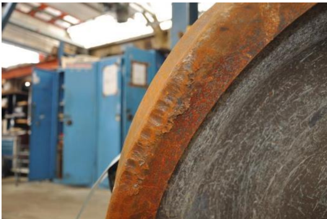
Figuur 18 : Binnendeel van de kraag van wiel A met groeven
