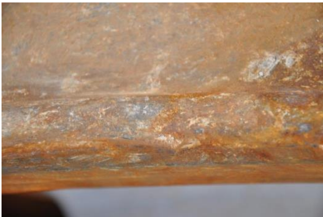
Figuur 40 : Beschadiging van de kraag van wiel B
