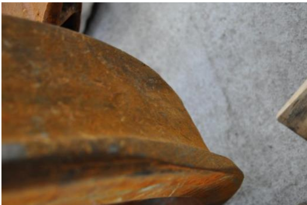
Figuur 44 : Beschadiging van de kraag van wiel B
