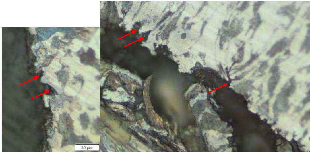
Figuren 119 en 120 : Breukoppervlak toont corrosie pitten die de korrelgrenzen volgen
