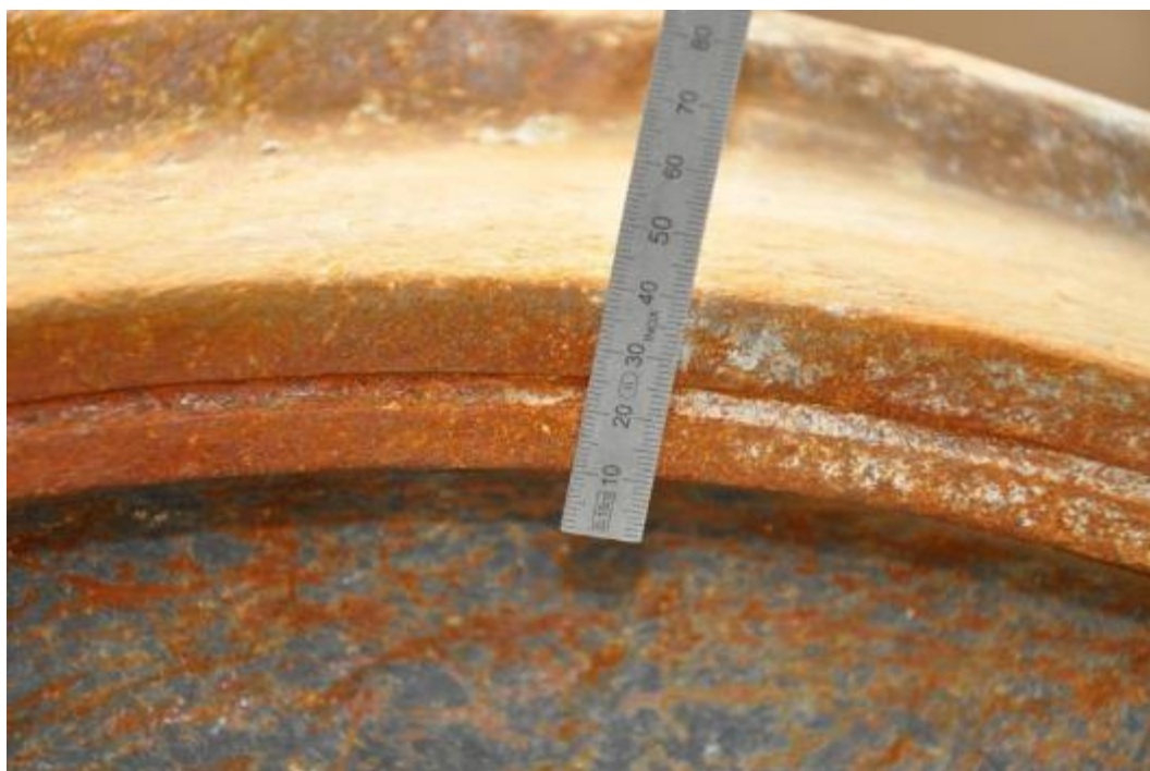
Figuur 55 : Sleetgroef van wiel B
