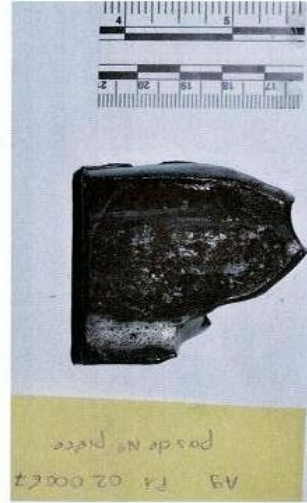
o Scelle N°P1 0200067 repère N°A9 : morceau de rail rompu
