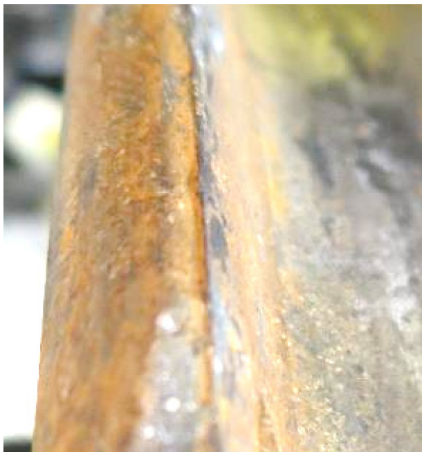
Abbildung 22: Spurkranzkuppe des erstentgleisten Rades mit Aufwölbung
