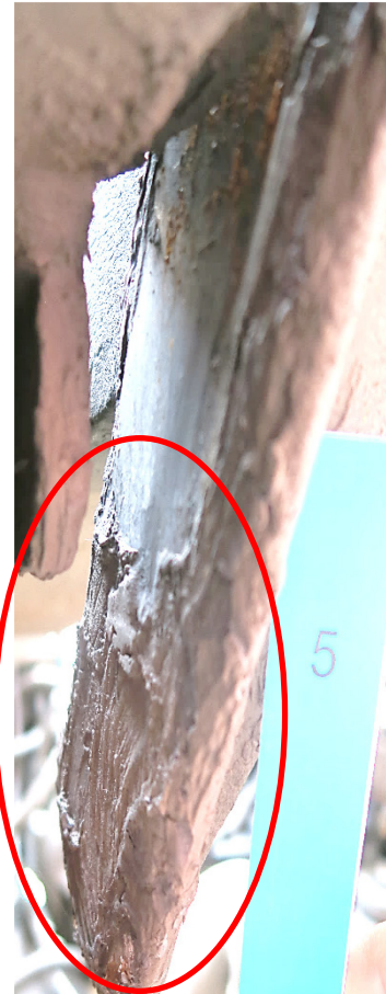
Abbildung 29: Längsmittnahme in Fahrtrichtung rechts unten; nicht auf vollständiger Länge genutzt (Kreis).
