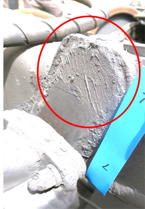
Abbildung 27: Längsmittnahme in Fahrtrichtung rechts oben; nicht auf vollständiger Länge genutzt (Kreis).
