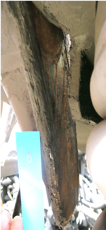
Abbildung 28: Längsmittnahme in Fahrtrichtung links unten; auf vollständiger Länge genutzt.
