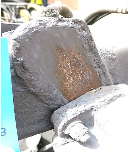
Abbildung 26: Längsmittnahme in Fahrtrichtung links oben; auf vollständiger Länge genutzt.
