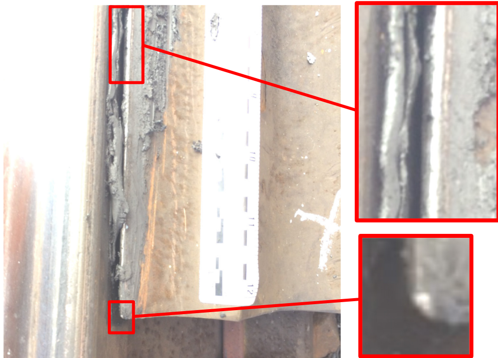
Abbildung 11: Spuren oben auf der Zungenspitze bei der Doppelkreuzungsweiche 63.
