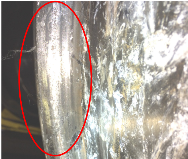
Abbildung 20: Trockene Spurkranzflanke am erstentgleisten Rad (Kreis).
