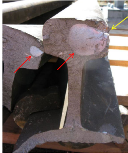
Abbildung 10: Metallisch glänzende Anrisszone im Schienenkopf (roter Pfeil) und Lippe am Schienenkopf (gelber Pfeil).
