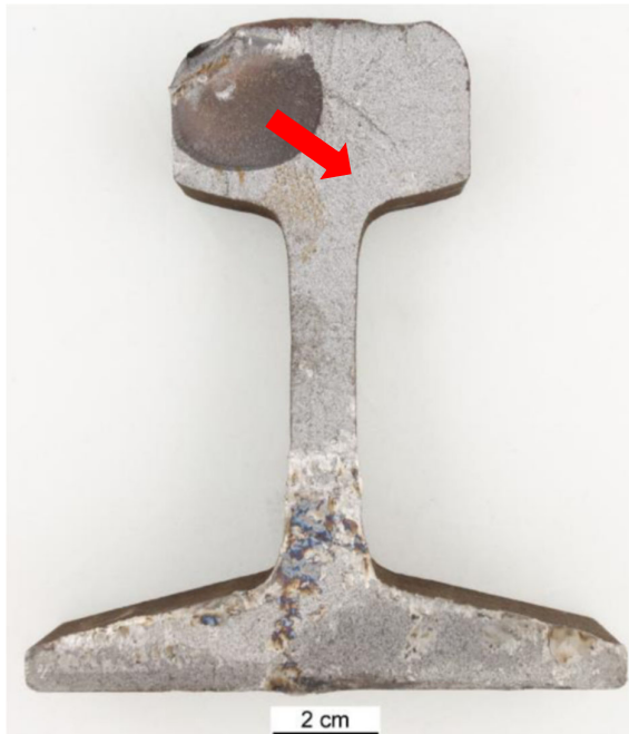
Abbildung 15: Fläche der Bruchposition Nr. 3 (gemäss Anordnung in Anlage 1) mit dunklem Bruchausgangsbereich und davon ausgehendem Rissfortschrittslinien im Restbruch.
