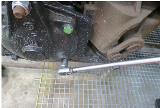
Abbildung 24: Überprüfung des Anzugsmoments der Achslagerdeckelschrauben.
