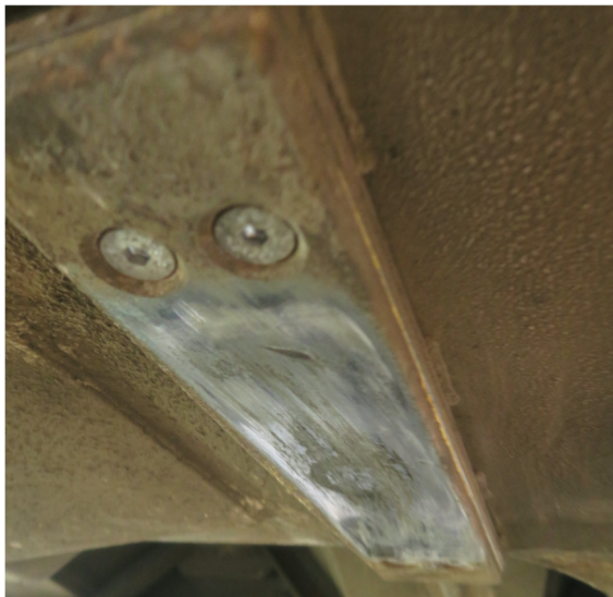
Abbildung 12: Stahlgleitplatte am Wagenuntergestell (DG 1, rechts).
