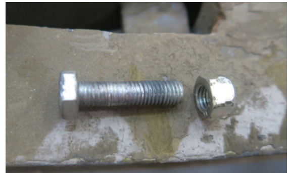
Abbildung 16: Befestigungsschraube des Nothalterungsträgers der Bremsgestänge, Gewinde abgenützt.
