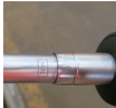
Abbildung 25: Gemessenes Anzugsdrehmoment von 320 Nm.
