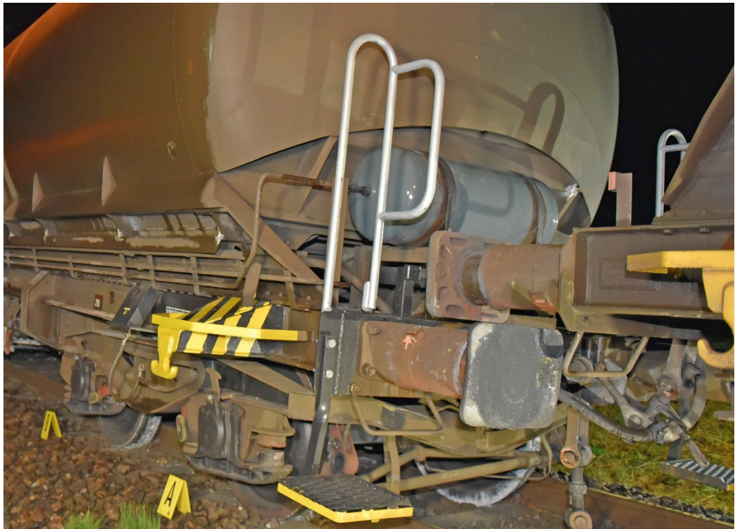
Abbildung 3: Entgleistes Drehgestell des fünften Kesselwagens (Quelle: Kantonspolizei Zürich).
