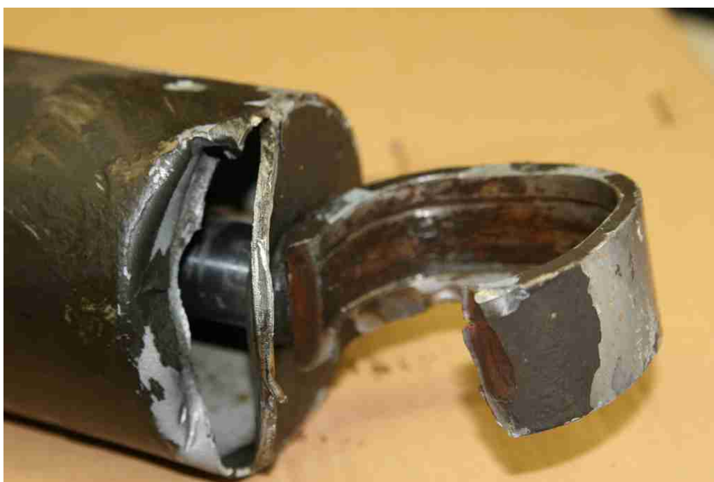
Obr. č. 8: Prasklé oko tlumiče sekundárního vypružení
