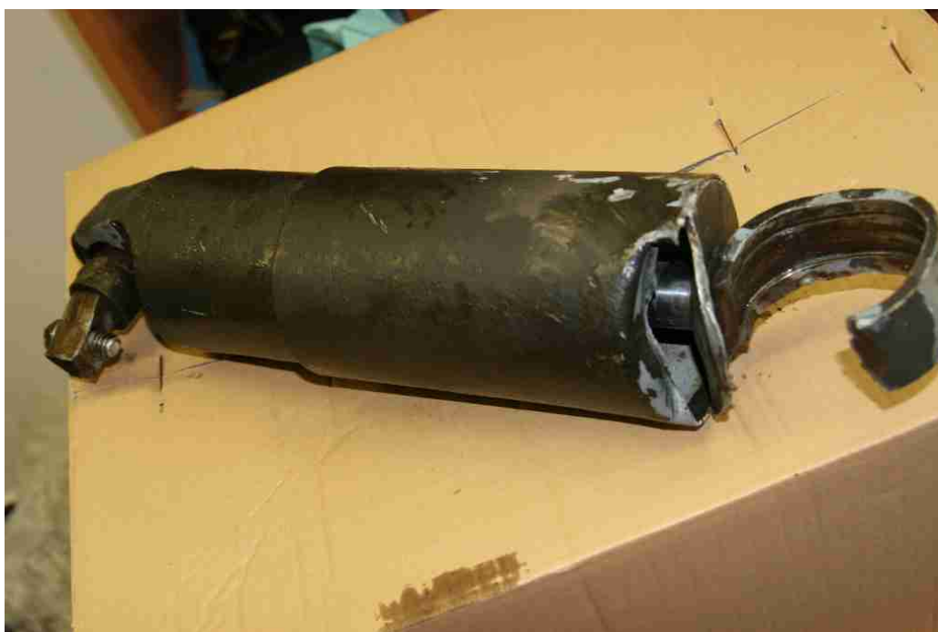
Obr. č. 7: Poškození tlumiče sekundárního vypružení
